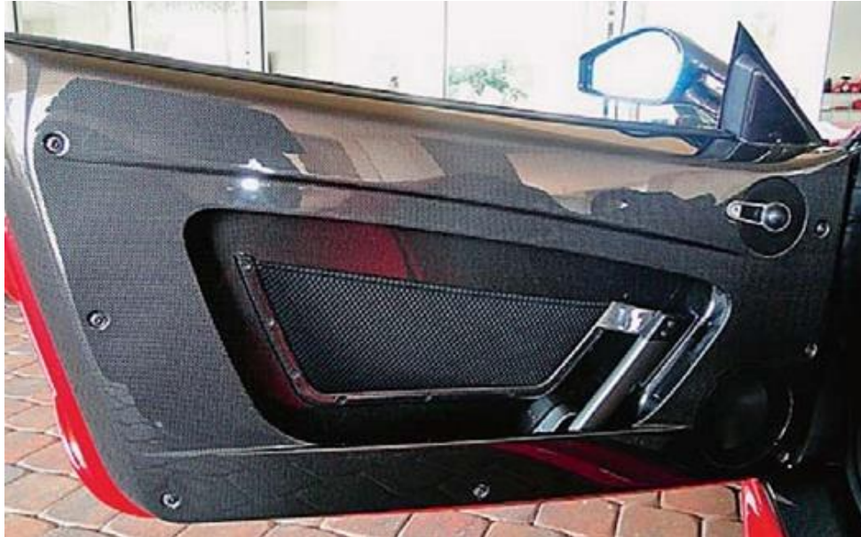
Slika 16. Paneli vrata načinjeni od plastomerne matrice ojačane ugljikovim vlaknima
