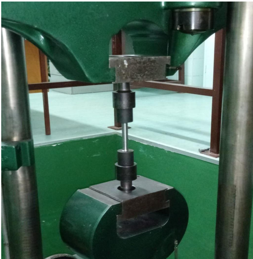
Slika 18. Čeljusti kidalice prilikom statičko vlačnog ispitivanja
