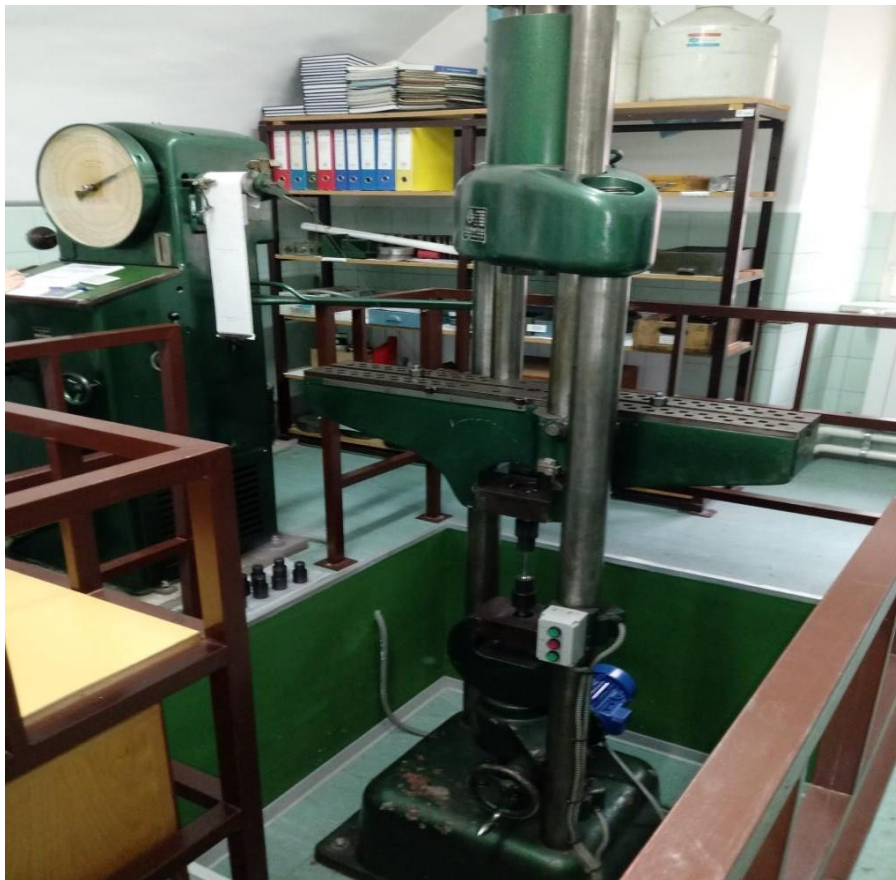
Slika 2. Kidalica: Otto Wolpert Werke
