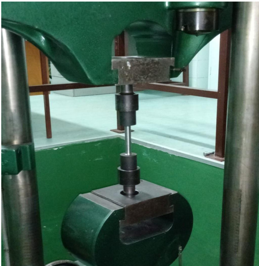
Slika 18. Čeljusti kidalice prilikom statičko vlačnog ispitivanja
