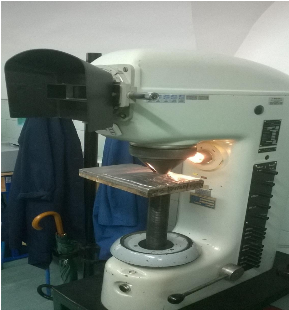
Slika 19. Tvrdomjer BRINELL-VICKERS na kojemu su provedena ispitivanja
