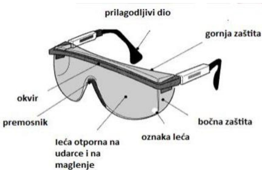
Slika 5: Dijelovi zaštitnih naočala [2]
