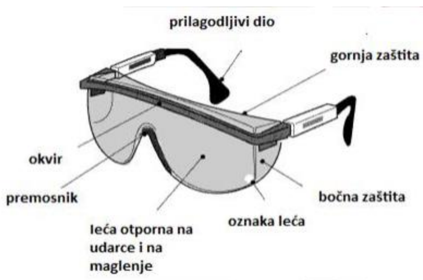
Slika 5: Dijelovi zaštitnih naočala [2]
