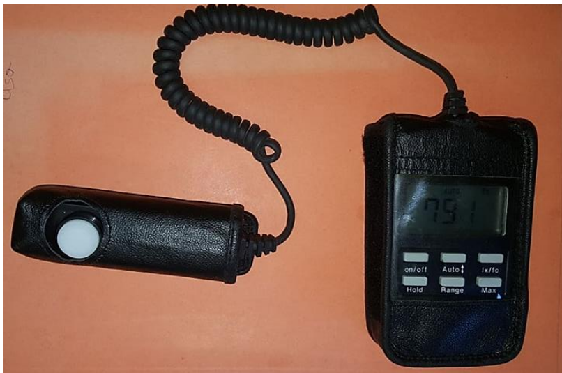
Slika 11. Mjerni uređaj (lux meter)
