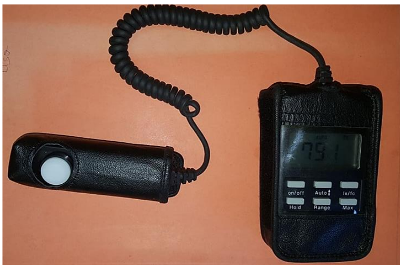
Slika 11. Mjerni uređaj (lux meter)
