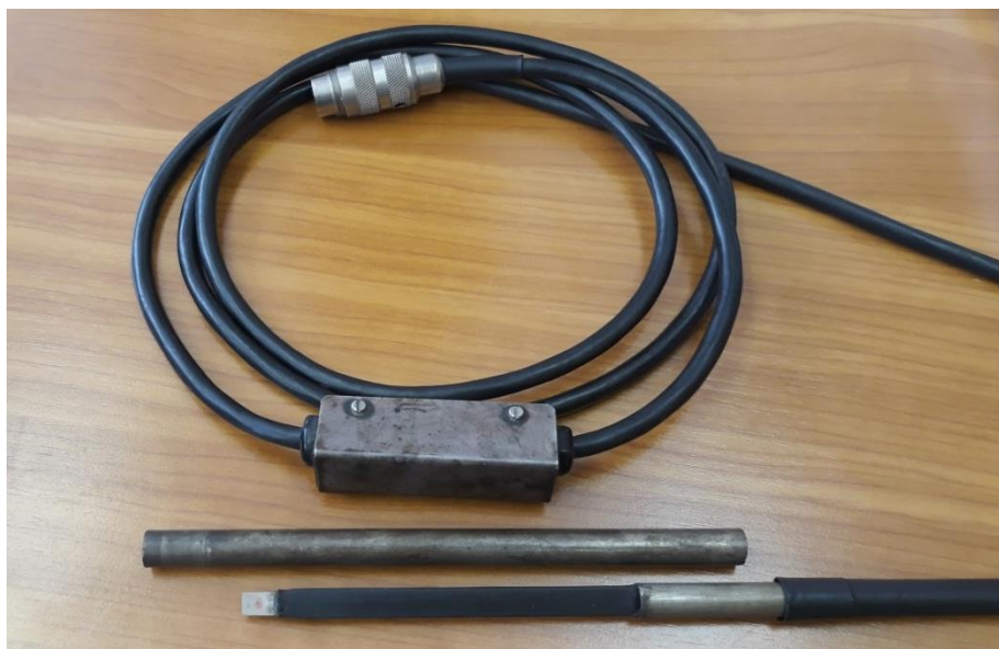
Slika 22. Fotografija Hallove sonde (model 687). Izvorno autor.
