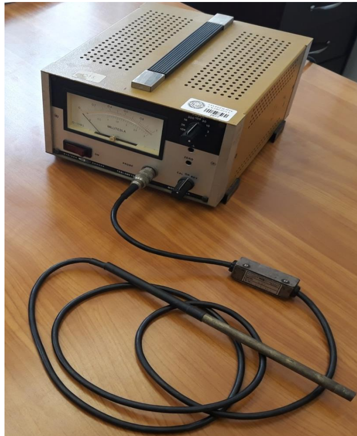
Slika 20. Fotografija teslametra SYSTRON DONNER (model 3103A). Izvorno autor.
