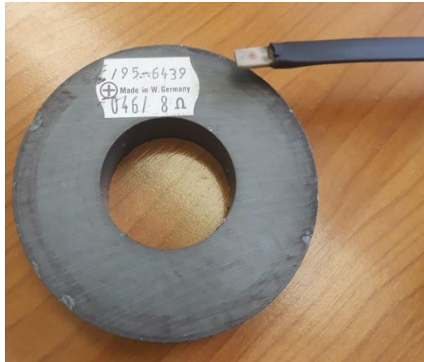
Slika 29. Fotografija mjerenja magnetske indukcije permanentnog magneta. Izvorno autor.
