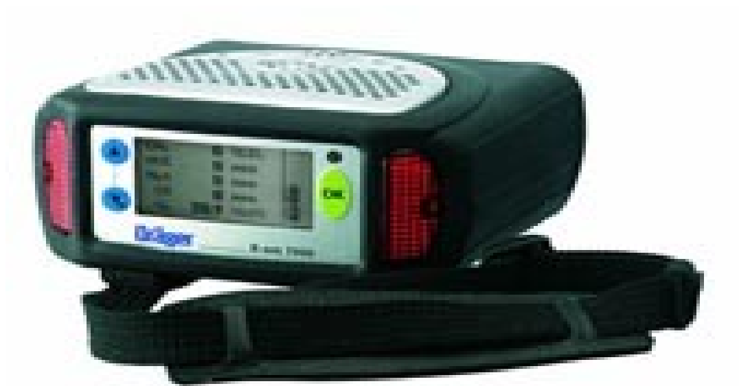
Slika 15. Detektor Dräger X-am 7000
