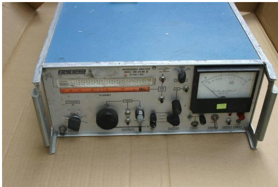
Slika 14. Predodžba uređaja Electrometrics EMC 25 MKIII [35].
