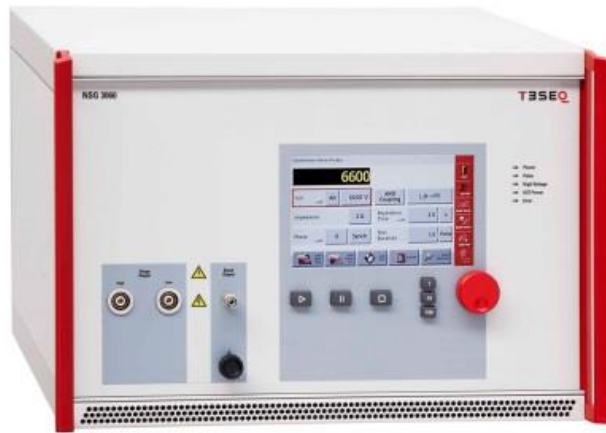
Slika 16. Predodžba uređaja NSG3060 za EMC testiranje [37].
