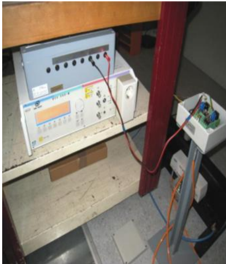
Slika 12. Predodžba ispitivanja otpornosti na udarne prenapone [34].
