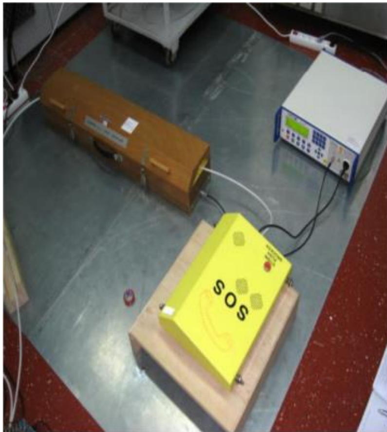
Slika 11. Predodžba ispitivanja otpornosti na brze tranzijante [33].
