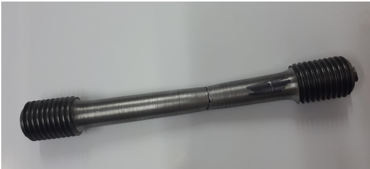
Slika 15. Epruveta nakon ispitivanja
