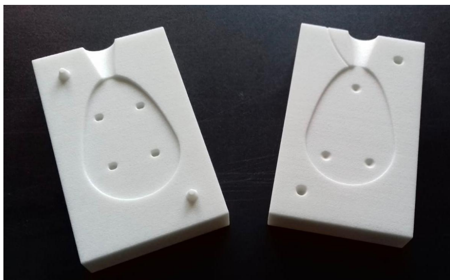
Slika 59. Gornji i donji dio kalupa za izradu utega
