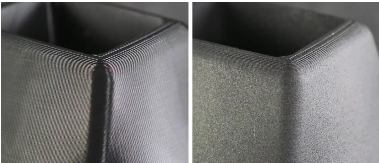
Slika 55. Površina prije i nakon sačmarenja [41]
