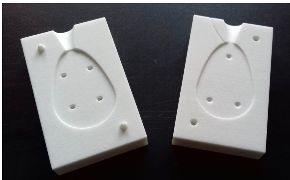
Slika 59. Gornji i donji dio kalupa za izradu utega
