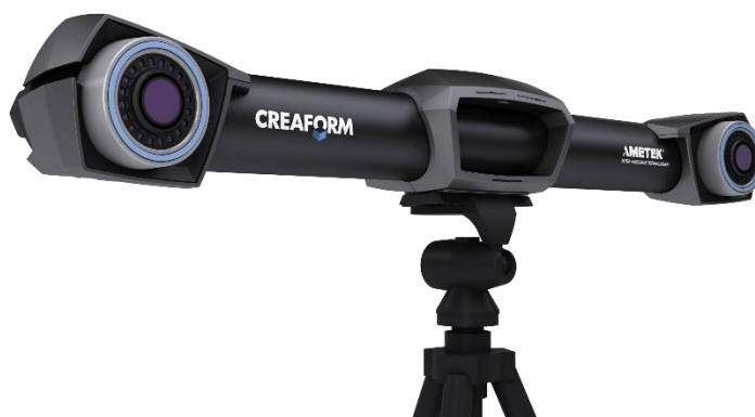
Slika 2. Primjer pasivne mjerne metode – Creaform C-track [5]
