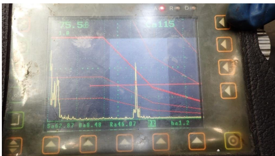
Slika 55. Echo-gram prihvatljive indikacije na vertikalnom tehnološkom zavaru. [2]
