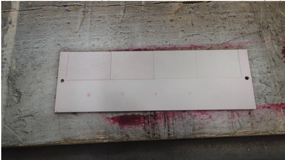
Slika 42. Razvijene indikacije na referentnom bloku. [2]
