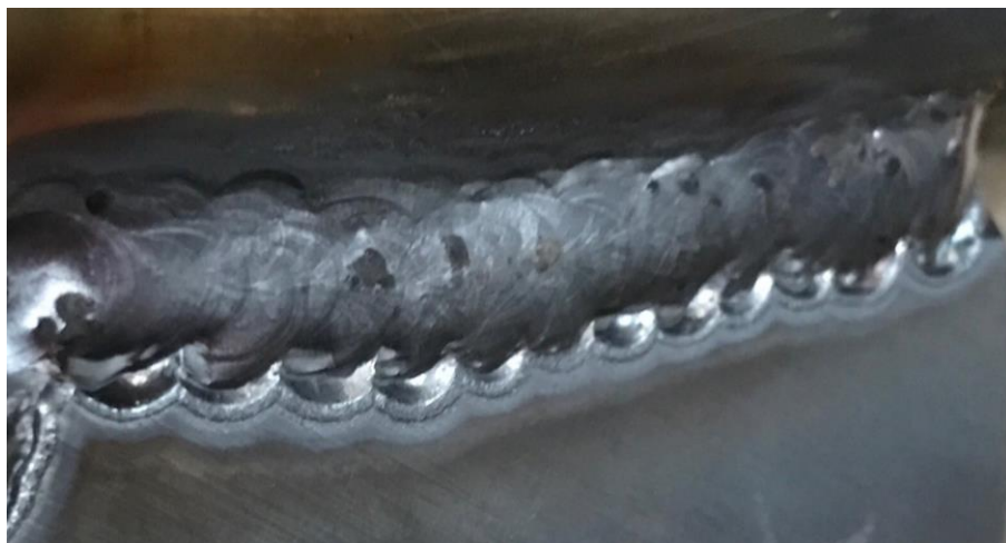
Slika 20. Primjer kontinuiranog zajeda. [9]
