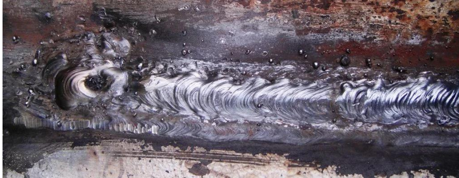
Slika 21. Primjer onečišćenja zavara kapljicama materijala. [2]
