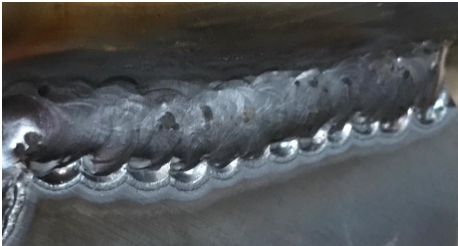
Slika 20. Primjer kontinuiranog zajeda. [9]
