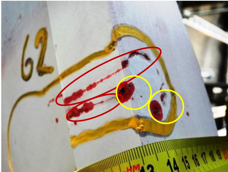
Slika 11. Prikaz linearnih i točkastih indikacija. 6 [2]
