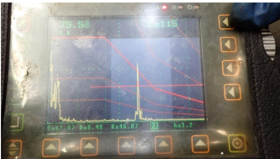
Slika 55. Echo-gram prihvatljive indikacije na vertikalnom tehnološkom zavaru. [2]
