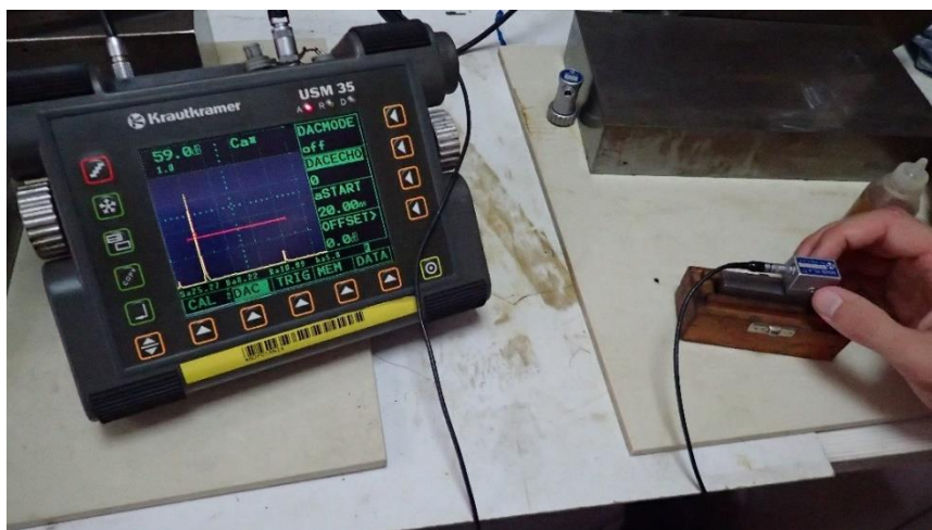
Slika 49. Kalibracija mjernog područja na kalibracijskom bloku V2. [2]
