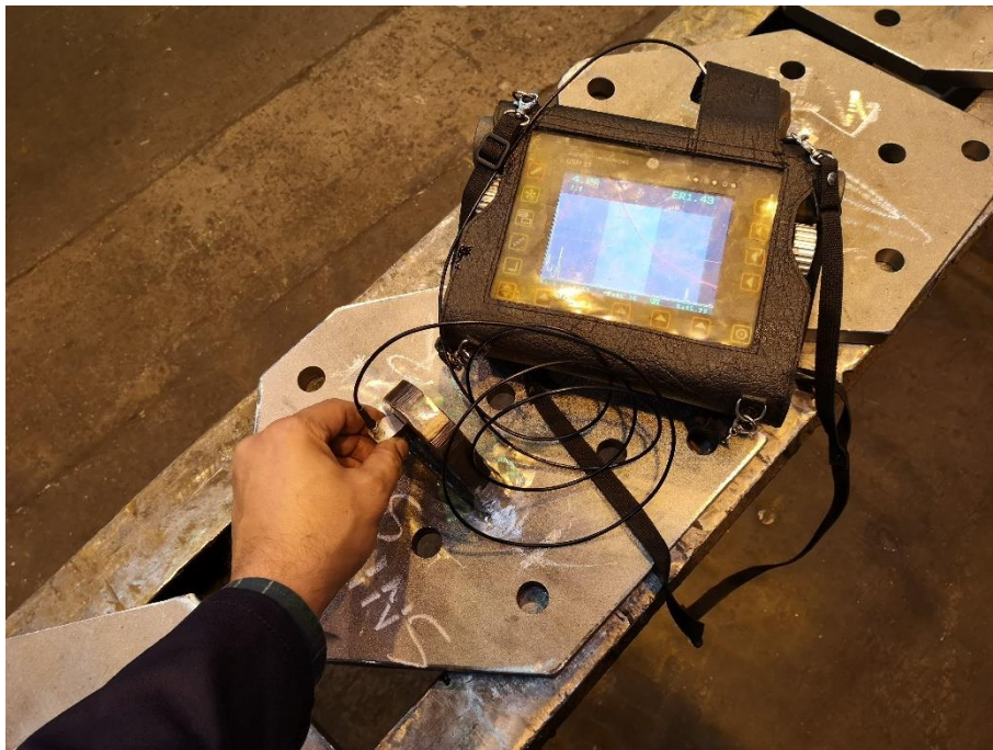
Slika 2. Ispitivanje zavora ultrazvučnom metodom. 2 [2]
