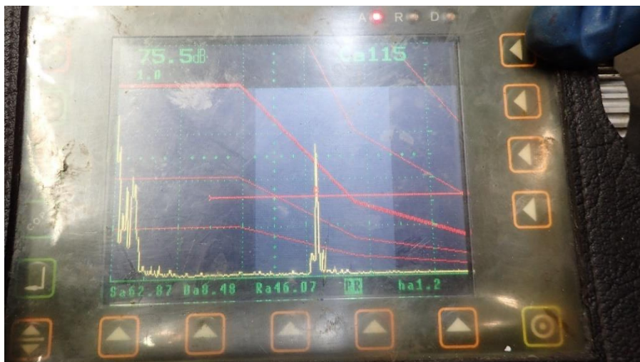
Slika 55. Echo-gram prihvatljive indikacije na vertikalnom tehnološkom zavaru. [2]
