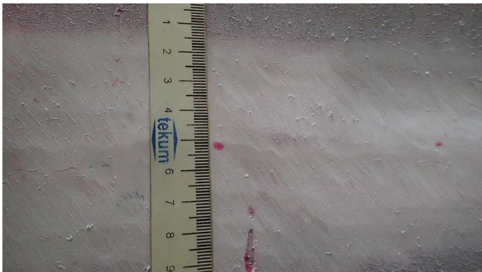
Slika 46. Detalj indikacije broj 1, dužine 4mm. [2]
