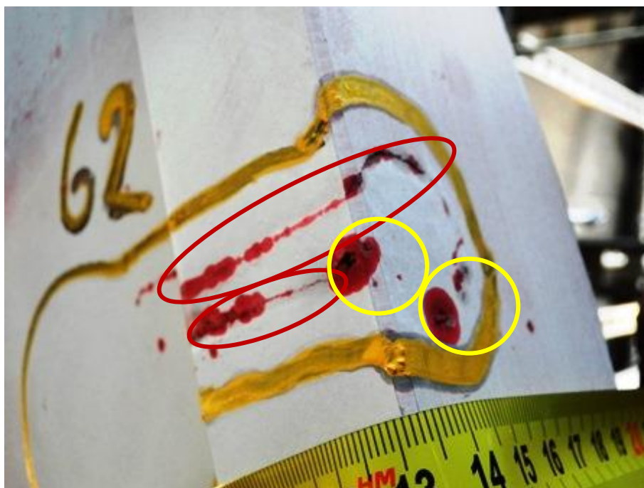
Slika 11. Prikaz linearnih i točkastih indikacija. 6 [2]
