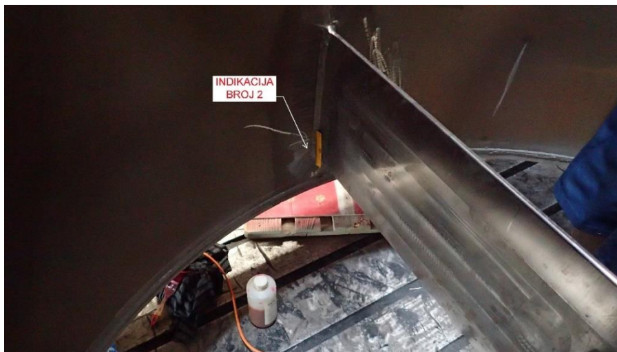
Slika 38. položaj indikacije broj 2 na nosaču glavine. [2]
