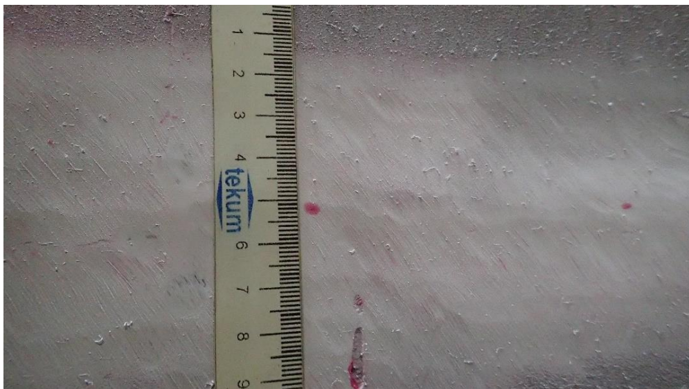
Slika 46. Detalj indikacije broj 1, dužine 4mm. [2]
