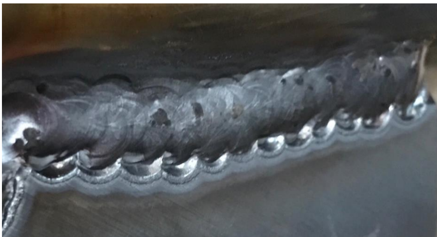
Slika 20. Primjer kontinuiranog zajeda. [9]
