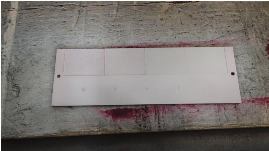
Slika 42. Razvijene indikacije na referentnom bloku. [2]
