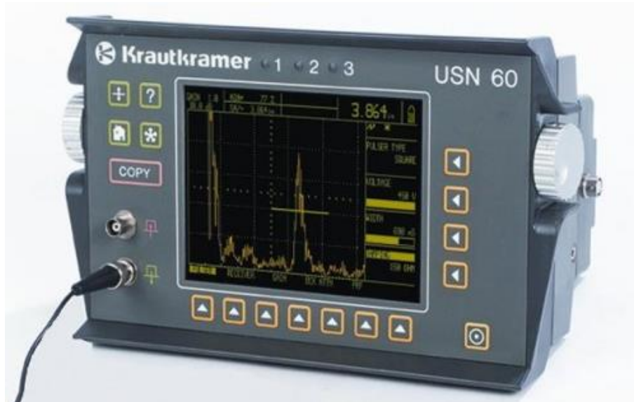
Slika 8. A-prikaz na ultrazvučnom aparatu. 3 [2]
