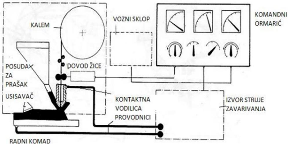
Slika 1.9 Shematski prikaz procesa EPP zavarivanja [6]
