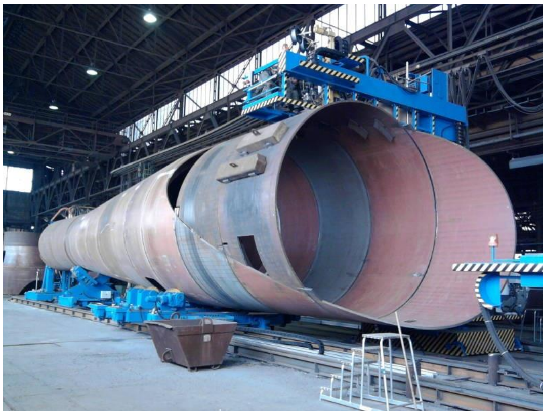
Slika 1.6 Portal za zavarivanje cijevi vjetroelektrane [4]
