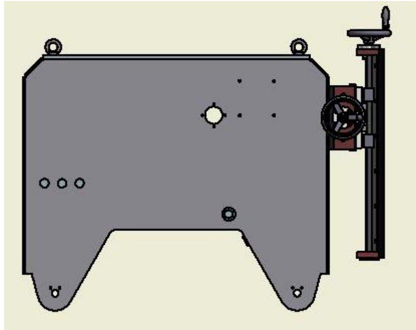
Slika 3.7 Horizontalni i vertikalni suporti za podešavanje pozicija glave za zavarivanje
