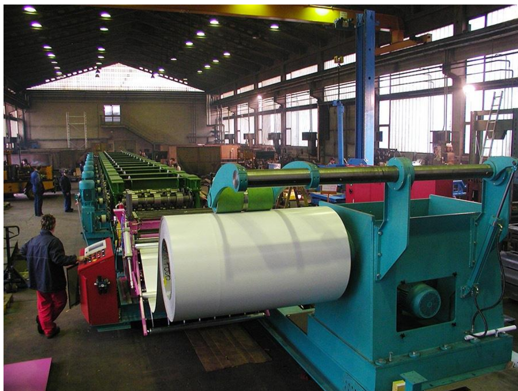
Slika 1.7 Stroj za profiliranje limova i traka [4]
