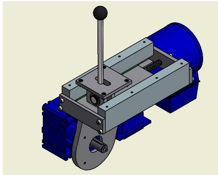
Slika 4.9 3D prikaz nosača motorreduktora
