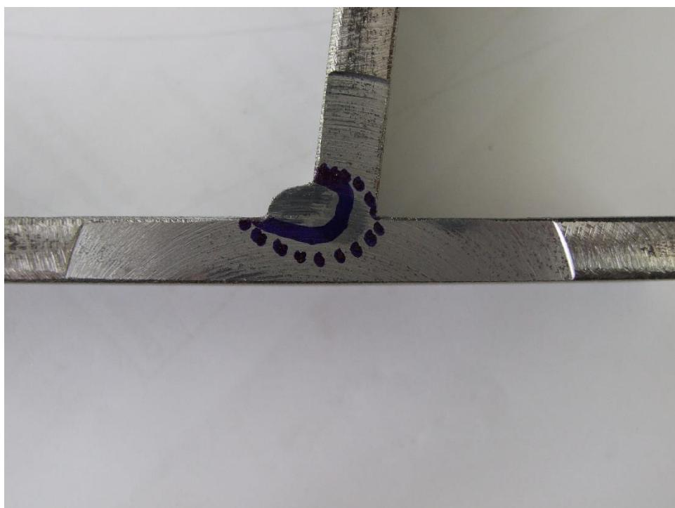
**Slika 6.4 Presjek zavara ispitnog uzorka**
