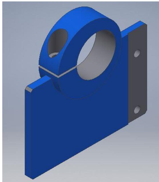
**Slika 3.3 Zakretni nosač kontaktne vodilice**
