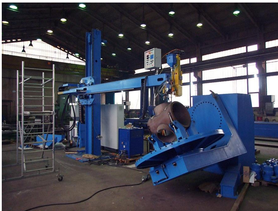
Slika 1.3 Stup za zavarivanje i pozicioner [4]
