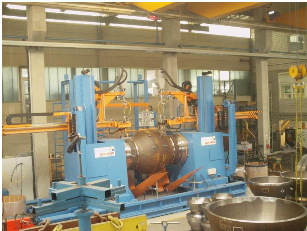
Slika 1.4 Uređaj za zavarivanje ventila [4]
