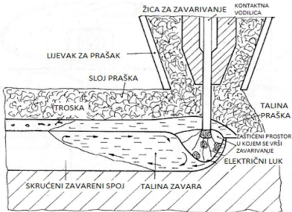
**Slika 1.8 Shematski prikaz procesa taljenja kod EPP zavarivanja [6]**
