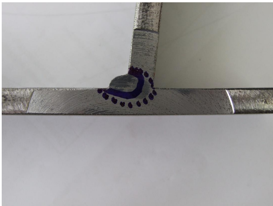
Slika 6.4 Presjek zavora ispitnog uzorka
