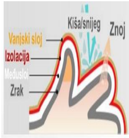
Sl. 5. Slojevi materijala kod rukavica za zaštitu od hladnoću[10]
