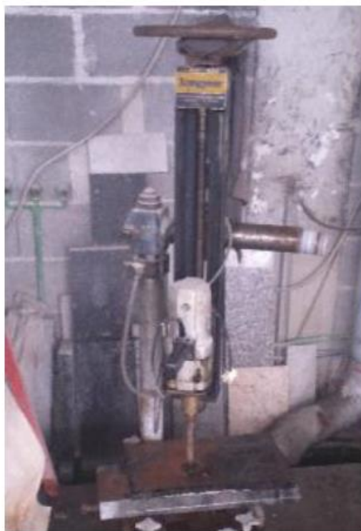
Slika 12. Stroj za probijanje kamena
