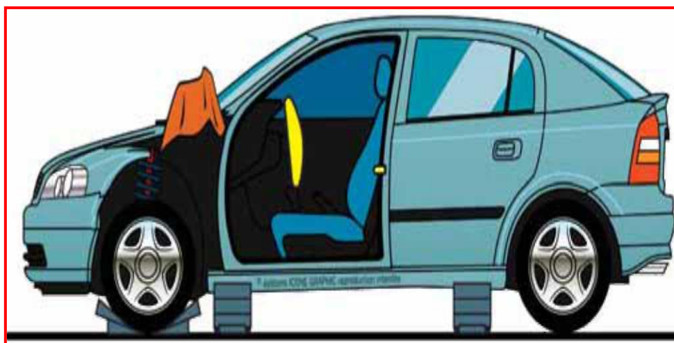
Slika 26. Uklanjanje vrata sa vozila.[1]
