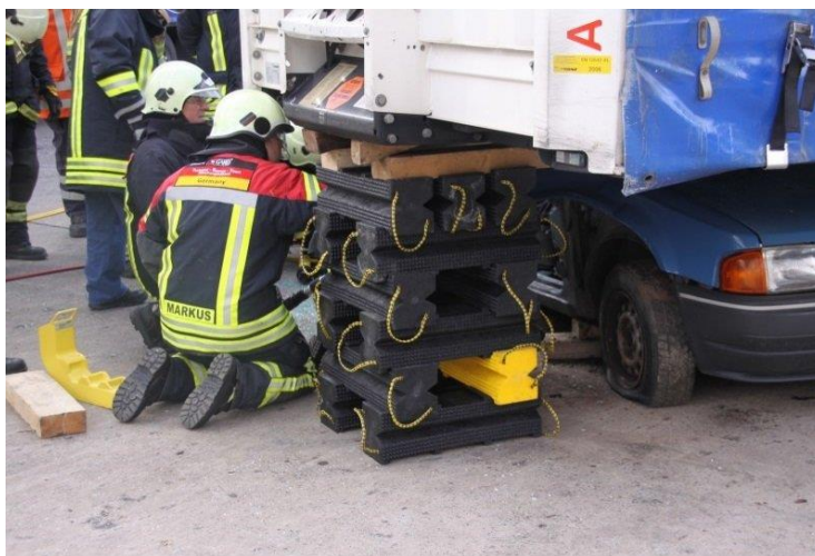
Slika 17. Stabilizacija vozila pomoću gredica i klinova.[12]
