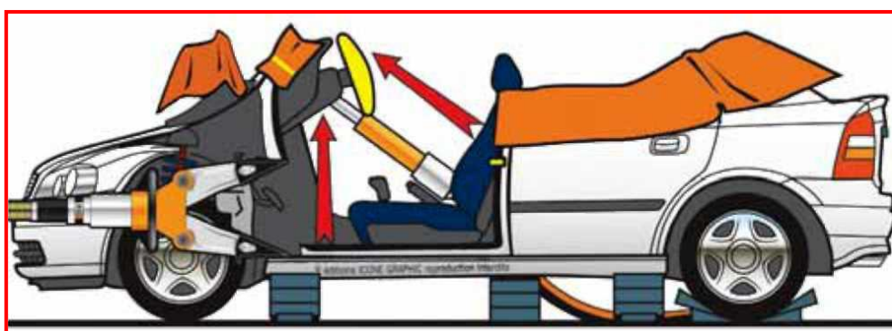
Slika 33. Stvaranje dodatnog prostora oko nogu pomoću razupirača.[1]
