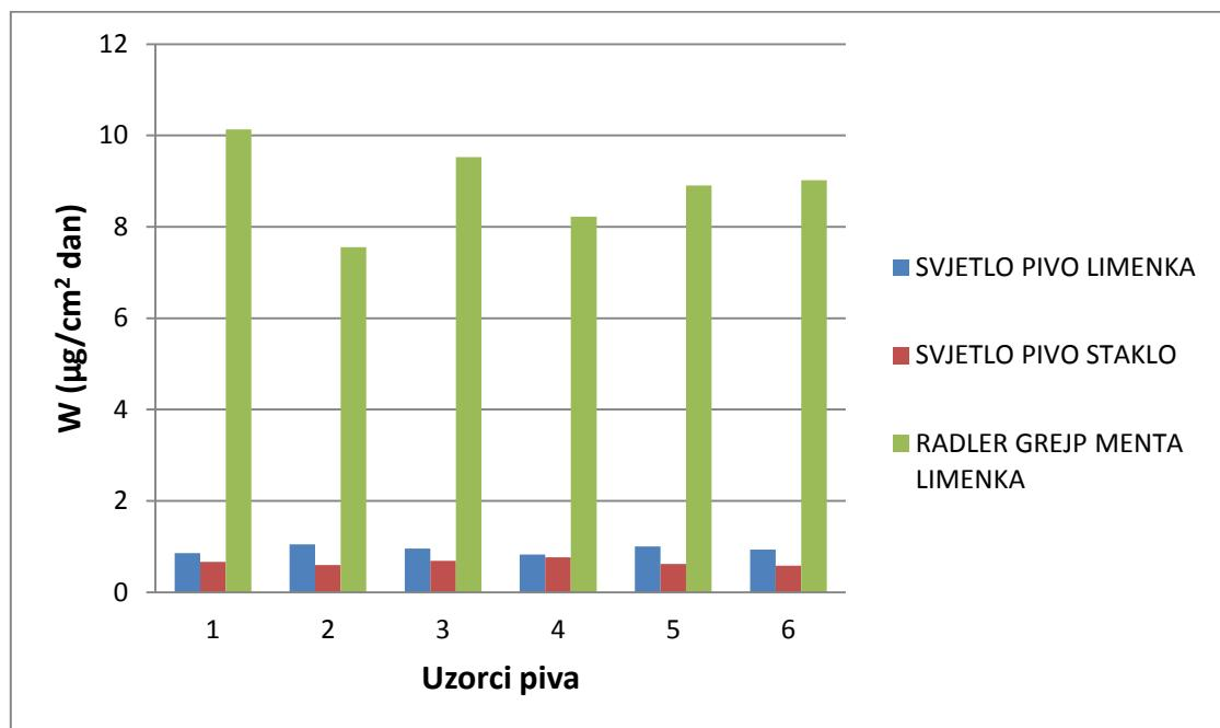
Slika 9. Brzine korozije aluminija ( $\mu\text{g}/\text{cm}^2 \text{ dan}$ ) u uzorcima piva određene gravimetrijskom metodom na 25°C.
