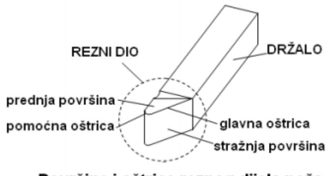
Slika 14. Elementi reznog alata. [11]
