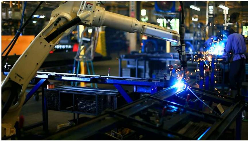
Slika 4: Robotska ruka s alatom za zavarivanje [5]
