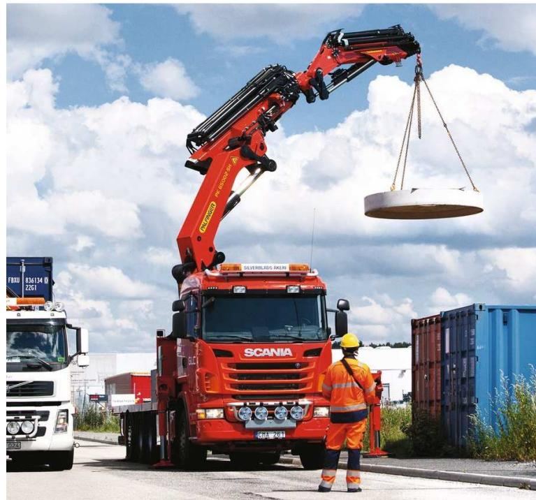
Slika 9: Vozilo s hidrauličkom rukom i prihvativnicom [9]
