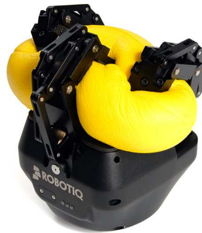
Slika 13: Prihvatnica s 3 čeljusti - hvatanje mekog predmeta [19]
