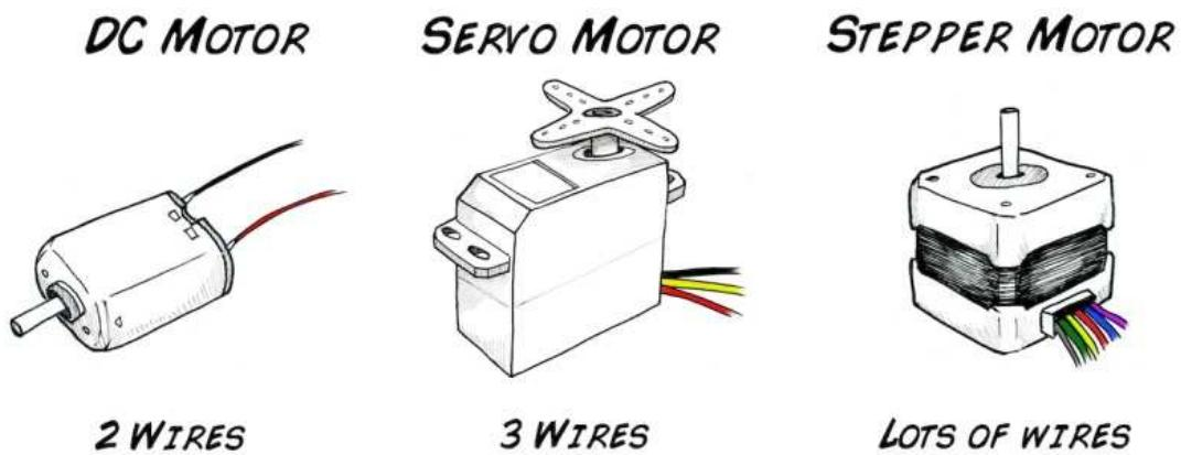
Slika 18: Tipovi istosmjernih motora [21]
