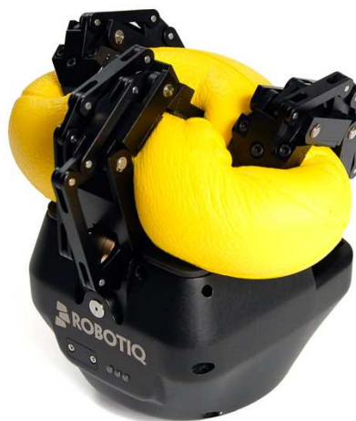
Slika 13: Prihvatnica s 3 čeljusti - hvatanje mekog predmeta [19]
