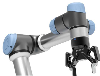
Slika 2: Robotska ruka s prihvatnicom [3]
