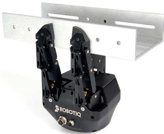
Slika 12: Prihvatanica s 3 čeljusti - hvatanje krutog predmeta [18]
