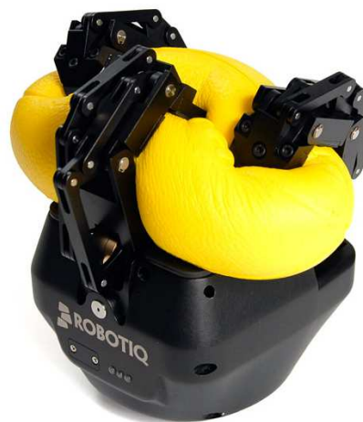
Slika 13: Prihvatanica s 3 čeljusti - hvatanje mekog predmeta [19]
