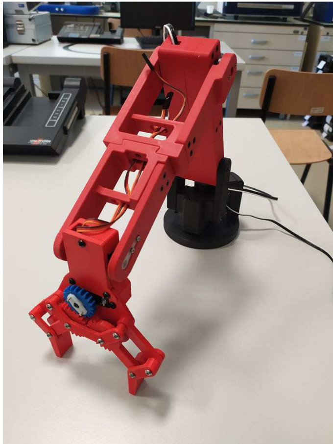
Slika 26: Izvedba robotske ruka sa 4SSG
