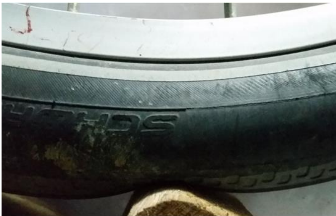
Slika 22. Mjerenje promjene geometrije gume 20x1.75" na izbočenoj podlozi.
