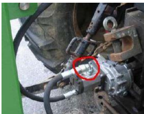
Slika 16. Pumpa spojena direktno na traktor [14]
