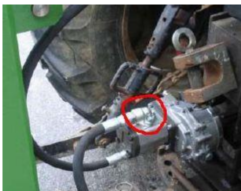
Slika 16. Pumpa spojena direktno na traktor [14]
