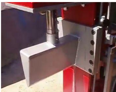
Slika 10. Prikaz najčešće izvedbe pomične sjekire [9]
