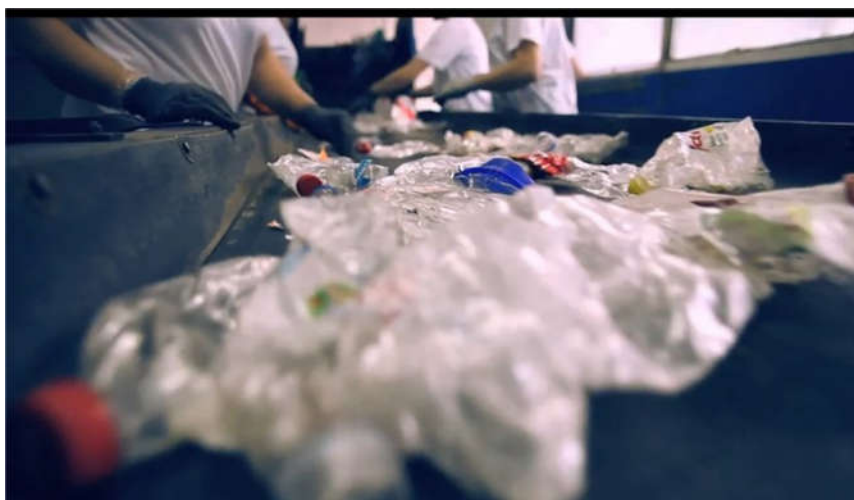
Slika 10. Ručno sortiranje komunalnog otpada 52
