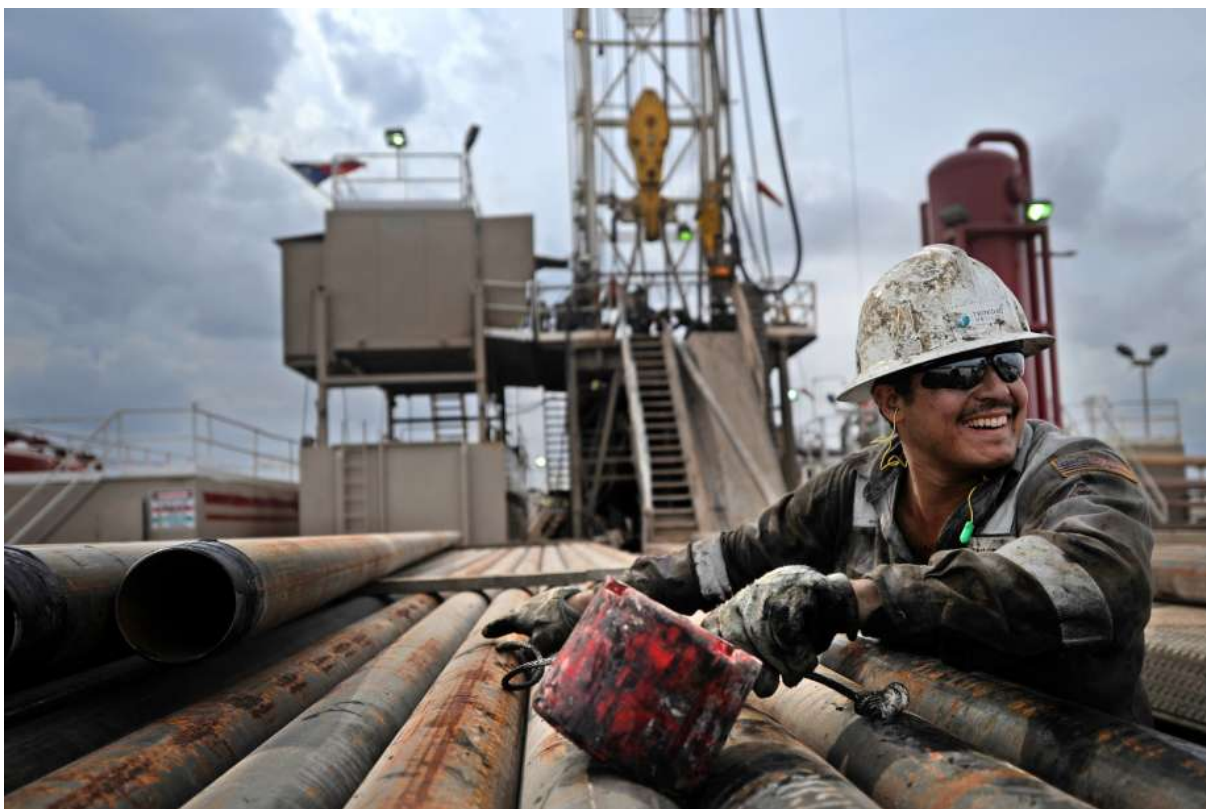
Slika 43. Pripremanje šipki za uvlačenje u toranj
