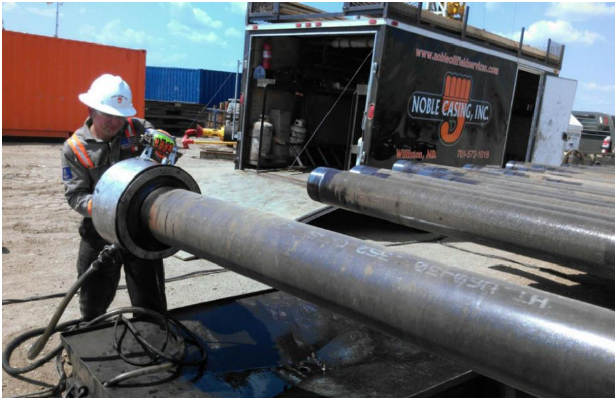
Slika 44. Pripremanje šipki za uvlačenje u toranj
