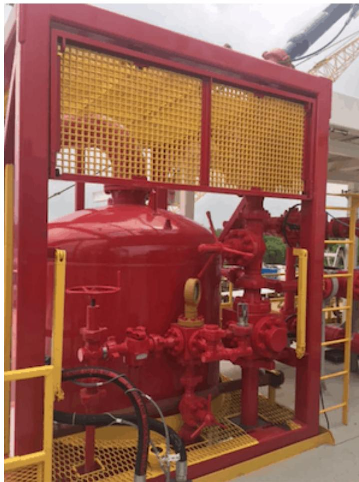
Slika 8. Prikaz manifold jedinice za stvaranje tlaka
