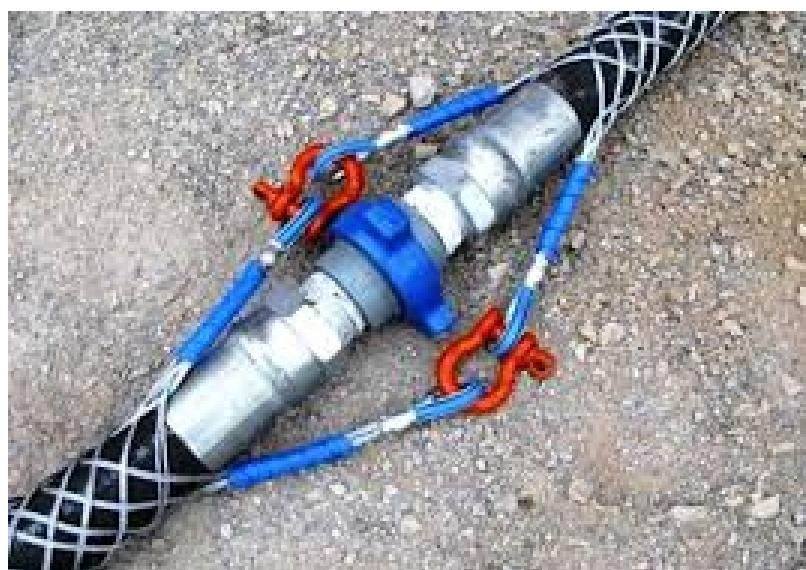
Slika 7. Whip arrestori za visokotlačne vodove
