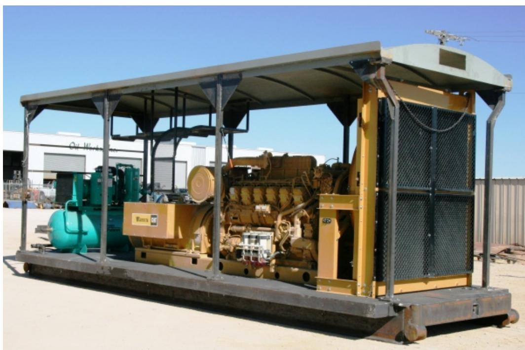
Slika 14. Tipičan izgled generatora na bušaćem postrojenju
