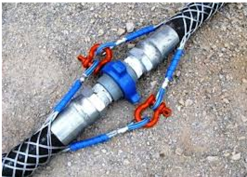
Slika 7. Whip arrestori za visokotlačne vodove
