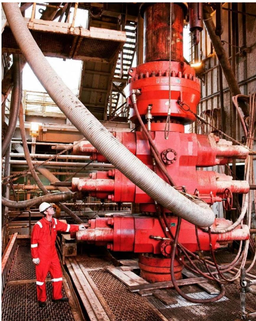
Slika 25. Prikaz BOP uređaja na kopnenoj bušačoj garnituri
