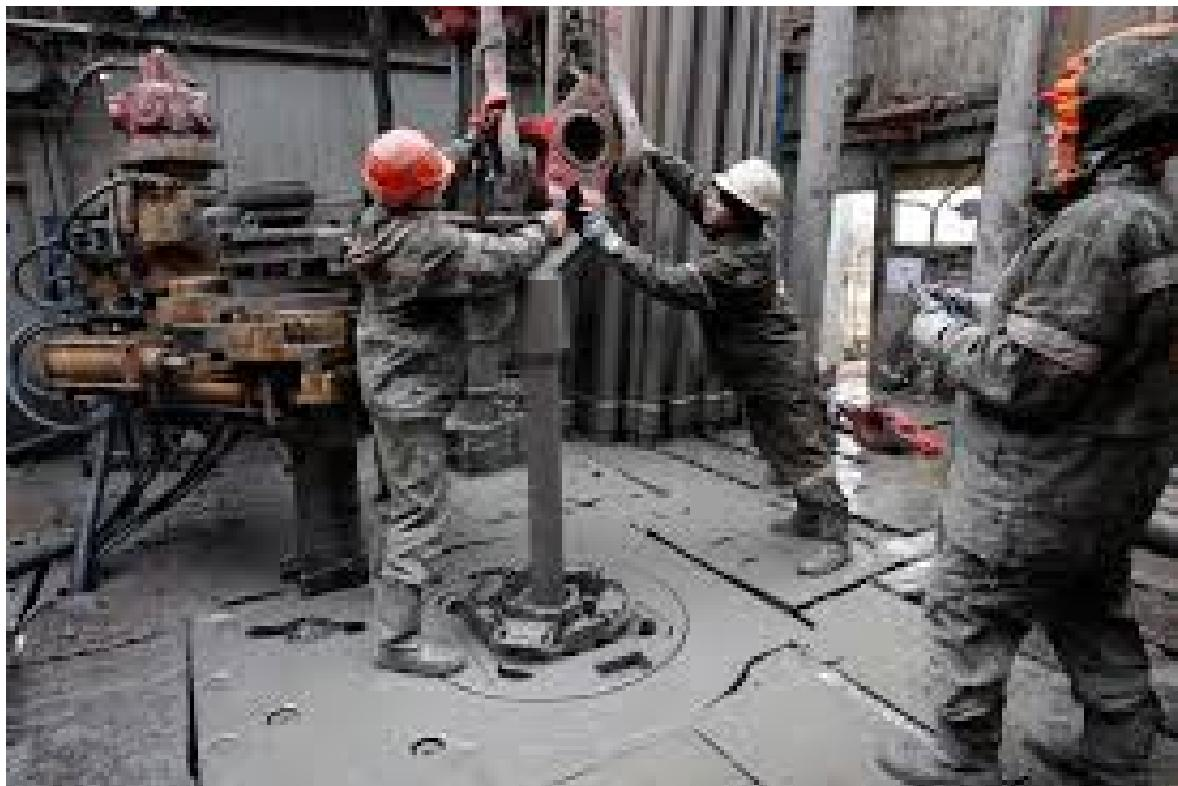
Slika 42. Dvoje radnika spajaju šipke, dok treći radnik čeka da ih zavrne hidrauličkim navrtačem
