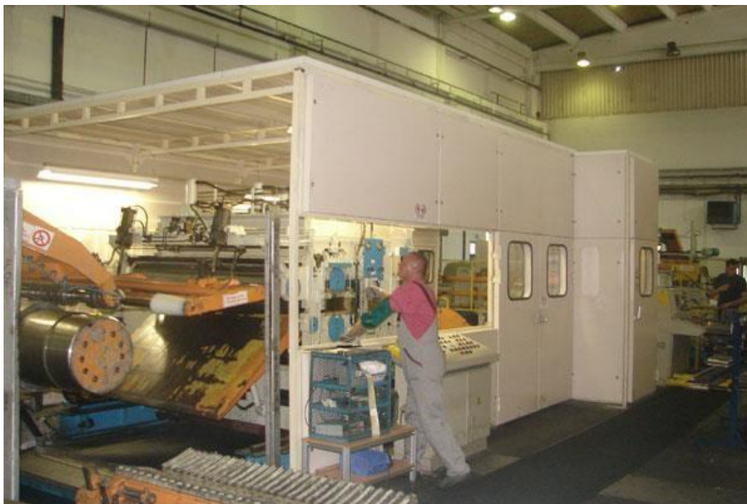
Slika 10. Primjer ograđenog stroja
