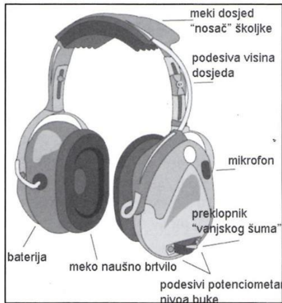
Slika 21. Presjek ušnog štitnika
