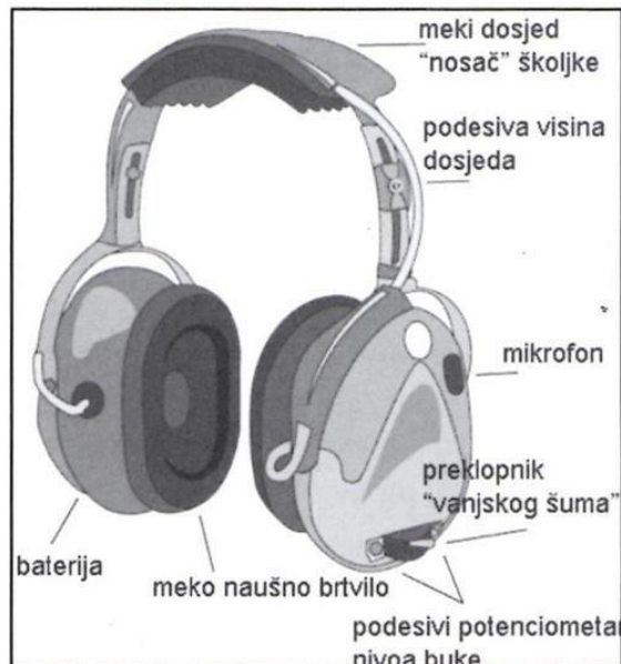
Slika 21. Presjek ušnog štitnika
