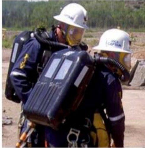
Slika 23 Aparat sa zatvorenim sustavom cirkulacije
