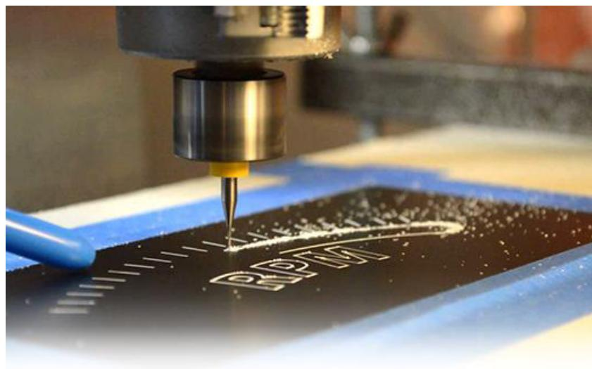
Slika 4. Prikaz CNC graviranja metalne ploče. [3]
