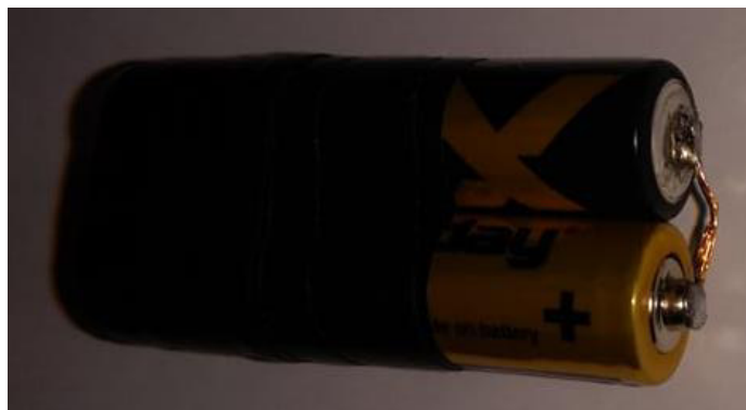
Slika 45. Prikaz zalemljenih i spojenih žicom AAA baterija
