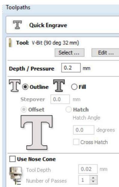
Slika 25. Odabir alata, dubina rezanja, način graviranja
