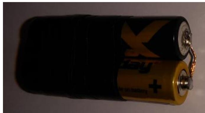
Slika 45. Prikaz zalemljenih i spojenih žicom AAA baterija
