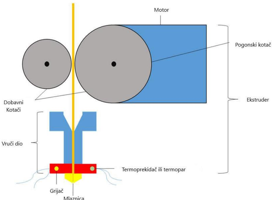
**Slika 10. Shematski prikaz izgleda extrudera**
