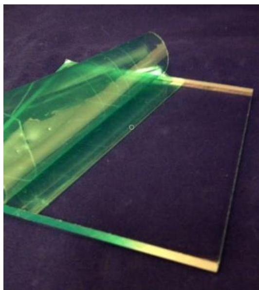
Slika 12. Slika obratka s odljepljenom zaštitnom folijom
