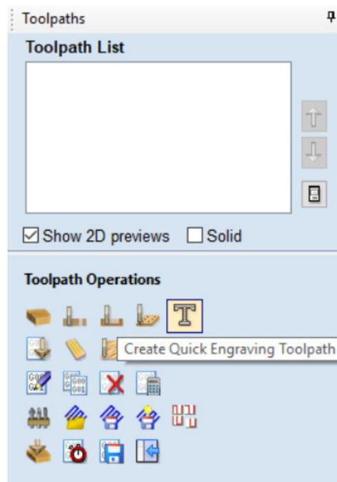
**Slika 23. Prikaz funkcije "Create Quick Engraving Toolpath"**
