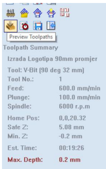
Slika 27. Funkcija „Preview Toolpath“ i sažetak podataka o obradi
