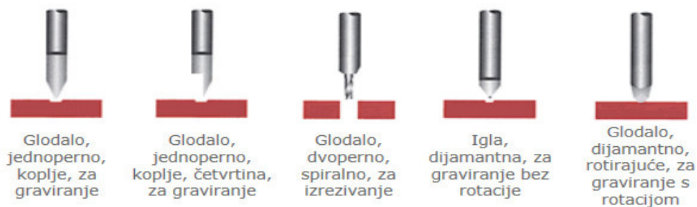
Slika 2. Glodala za graviranje [8]
