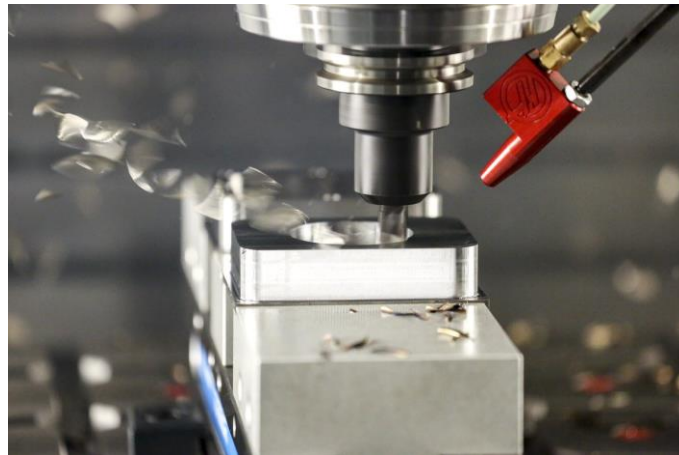
Slika 6. Glodanje džepa HAAS
