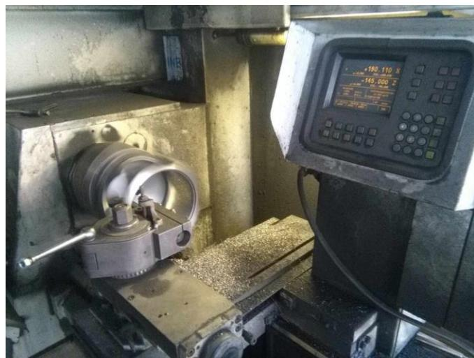
Slika 12. Grubo tokarenje na ciklus tokarilici
