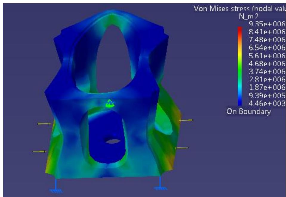
Slika 34. Raspodjela ekvivalentnog naprezanja pri stezaju
