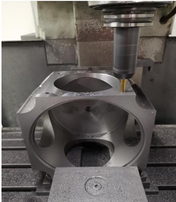
Slika 20. Bušenje provrta
