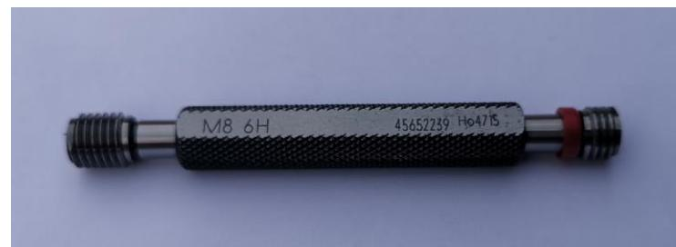
Slika 31. Kontrolni kalibar za M8
