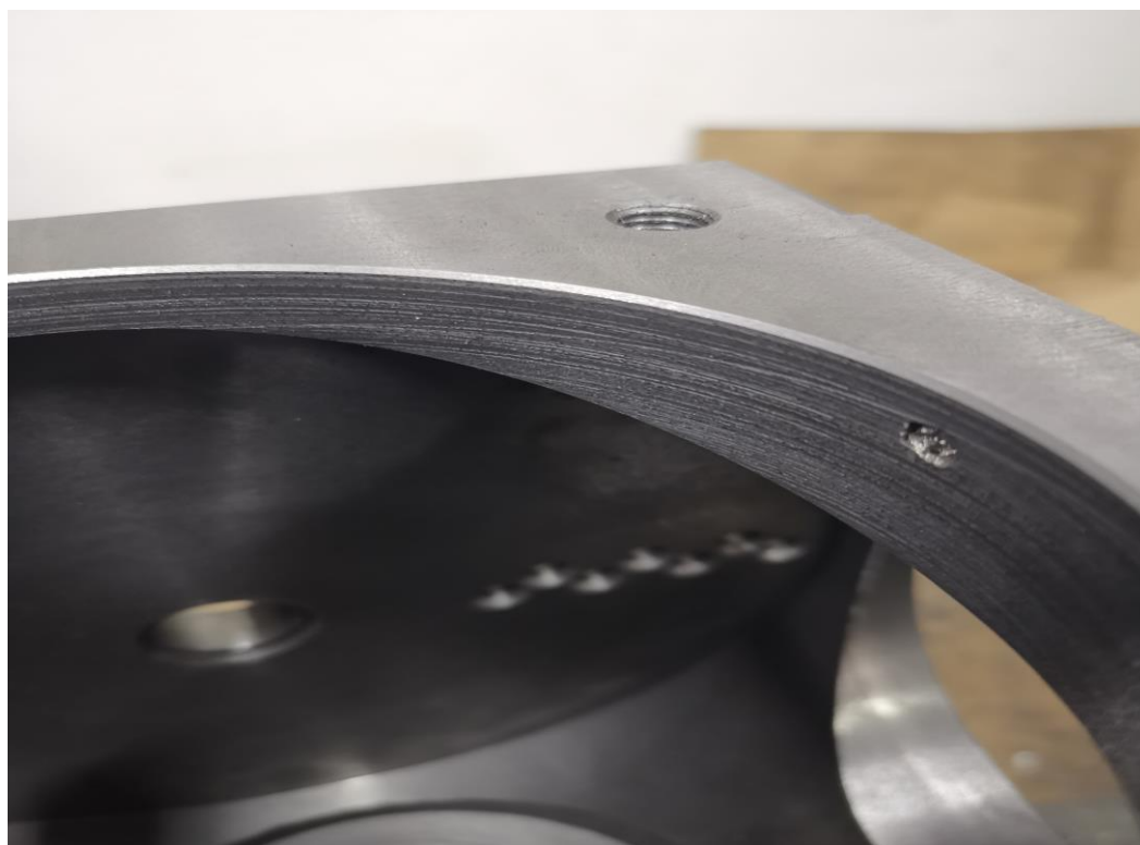
Slika 40. Posljedice vibracija zbog nehomogenosti materijala
