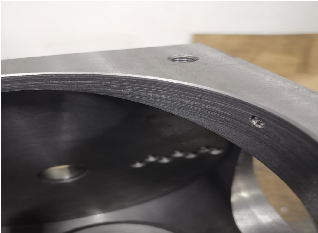
Slika 40. Posljedice vibracija zbog nehomogenosti materijala
