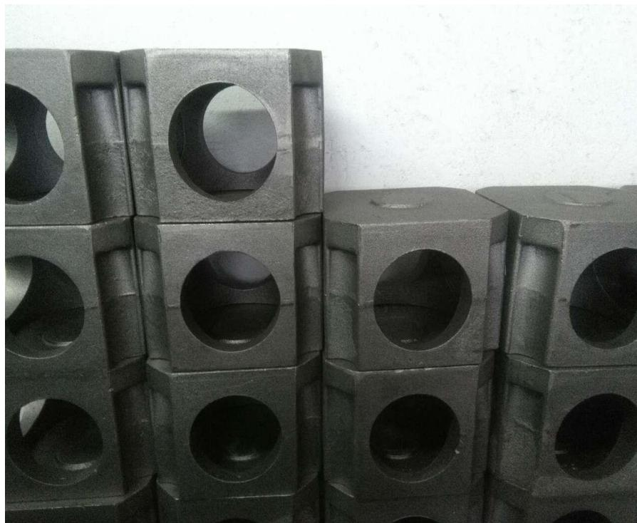
Slika 8. Poluproizvodi – odljevci sivog lijeva
