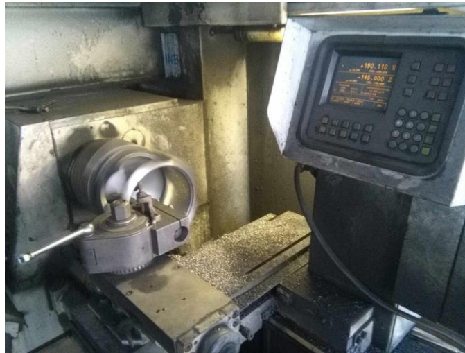
Slika 12. Grubo tokarenje na ciklus tokarilici
