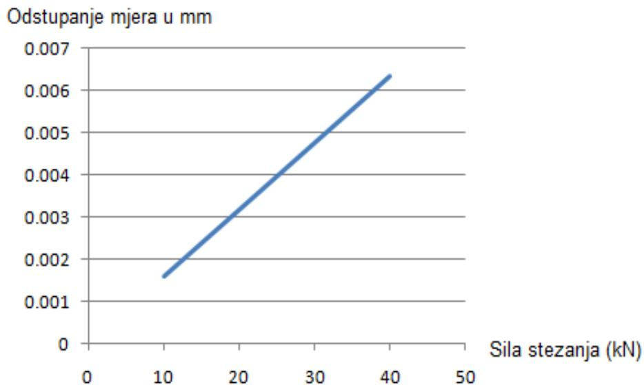
Dijagram 1. Ovisnost sile stezanja i odstupanja mjeru
