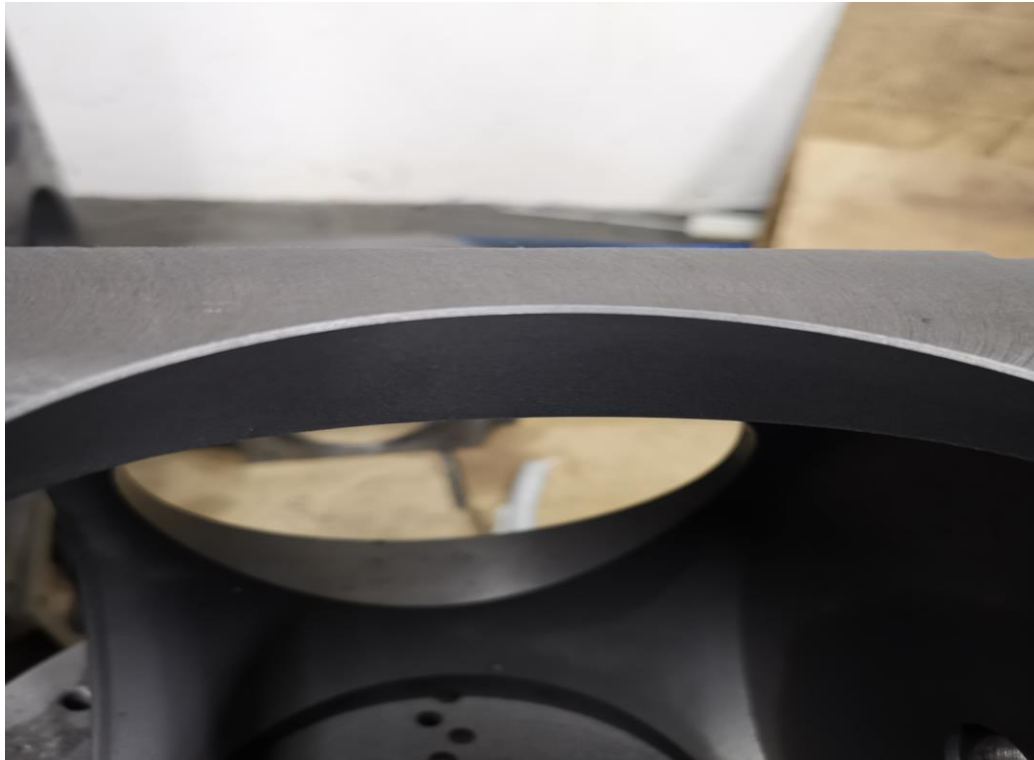
Slika 39. Prikaz kvalitetne površine kod istokarivanja
