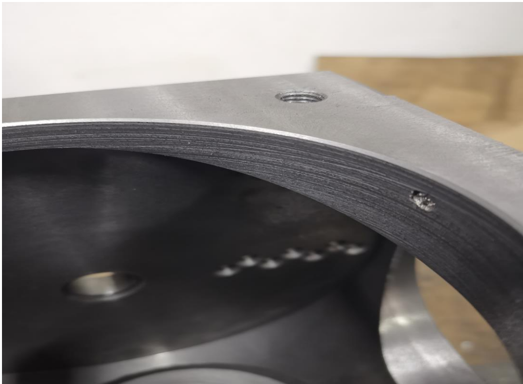
Slika 40. Posljedice vibracija zbog nehomogenosti materijala
