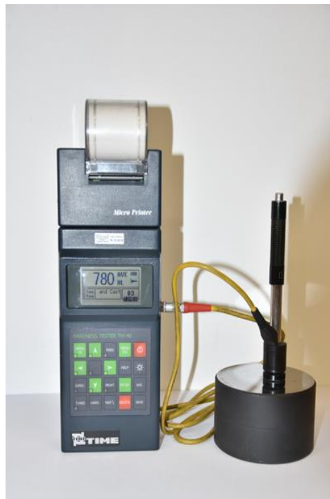
Slika 7. Prijenosni digitalni tvrdomjer TH140 za veće odljevke (BONAP)
