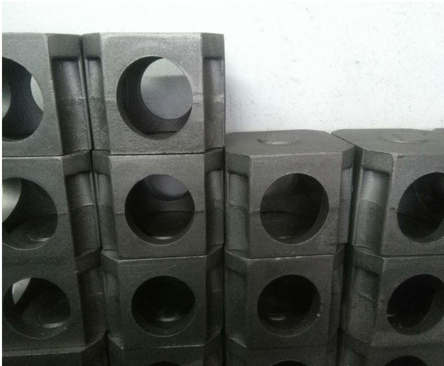
Slika 8. Poluproizvodi – odljevci sivog lijeva
