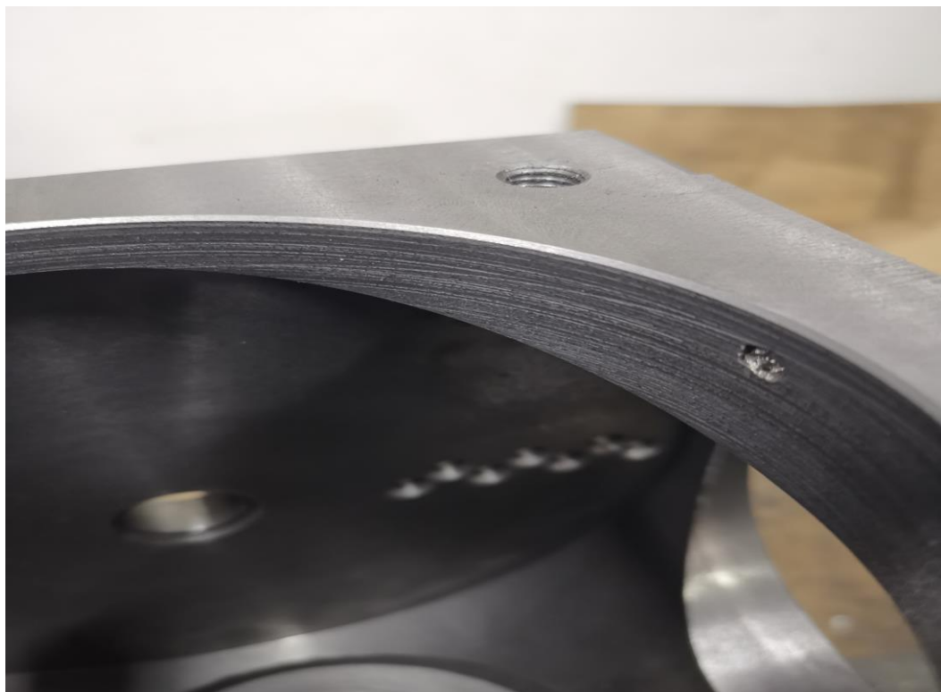
Slika 40. Posljedice vibracija zbog nehomogenosti materijala
