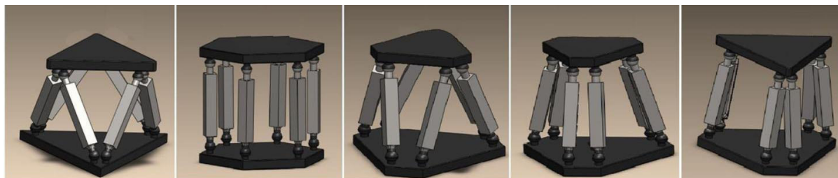
Slika 2-19. Osnovne konfiguracije s obzirom na razmještaj zglobova na platformama
