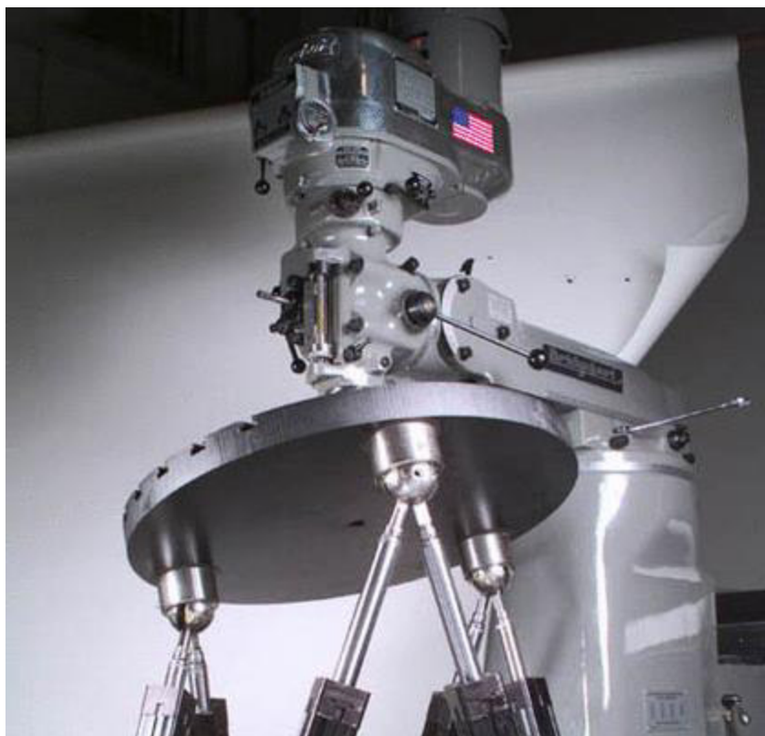
Slika 2-7. Primjena u alatnim strojevima za precizno kretanje između alata i radnog prostora
