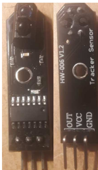
Slika 21: Prednja i zadnja strana senzora HW-006 v1.2
