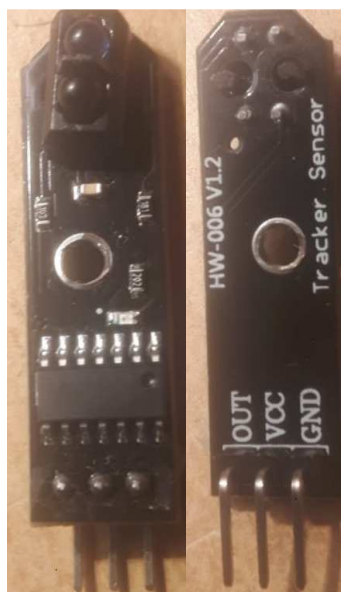
Slika 21: Prednja i zadnja strana senzora HW-006 v1.2
