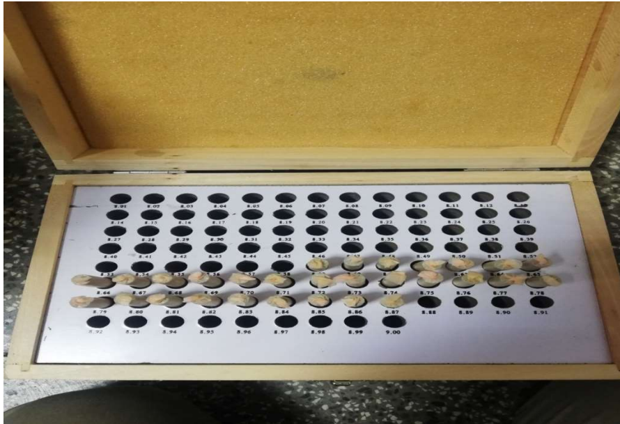
Slika 14. Razvrstavanja kalibara za provrte
