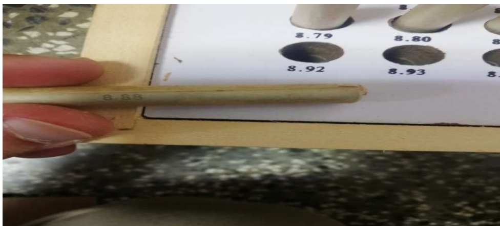
Slika 15. Primjer označavanja jednog kalibra
