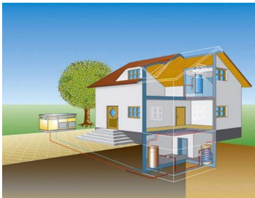
Slika 8. Prikaz sustava dizalica topline zrak-voda
