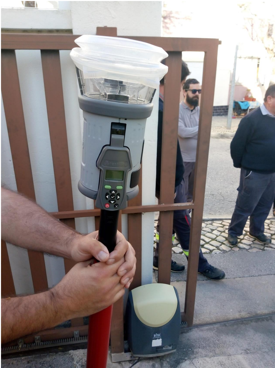
Slika 18. – Predodžba - Uređaj za aktivaciju detektora dima (slika autora)
