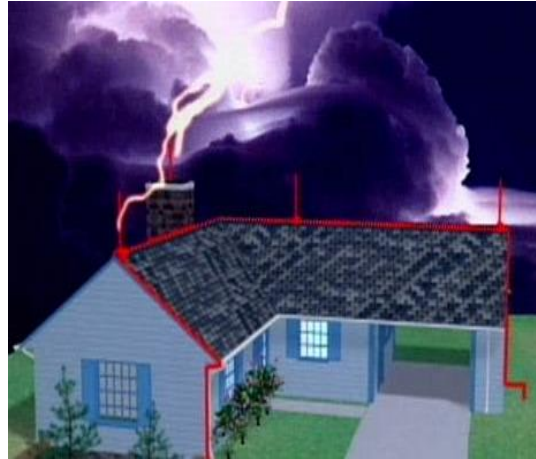
Slika 7. Prikaz gromobranske instalacije[19]
