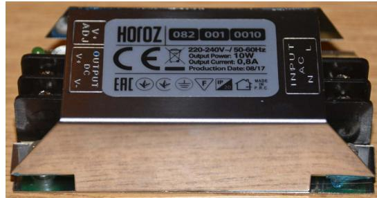
Slika 35. LED driver s mogućnošću podešavanja izlaznog napona
