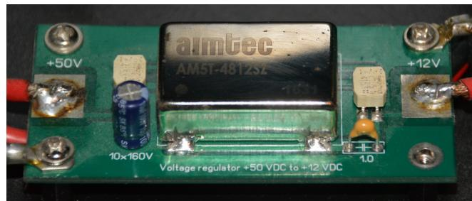
Slika 34. 12V modul Aimtec AM5T-4812SZ
