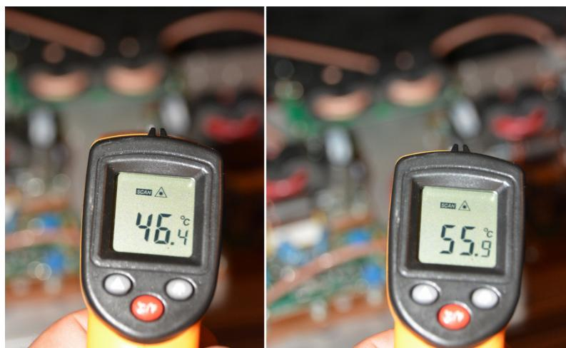
Slika 38. Mjerenje temperature hladnjaka i LDMOS-a beskontaktnim termometrom
