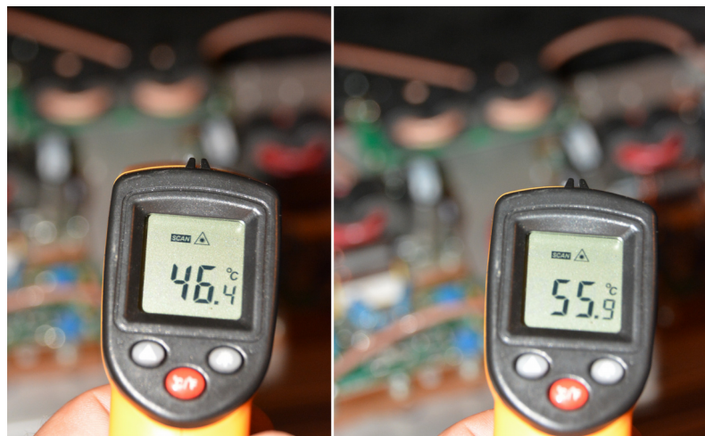
Slika 38. Mjerenje temperature hladnjaka i LDMOS-a beskontaktnim termometrom
