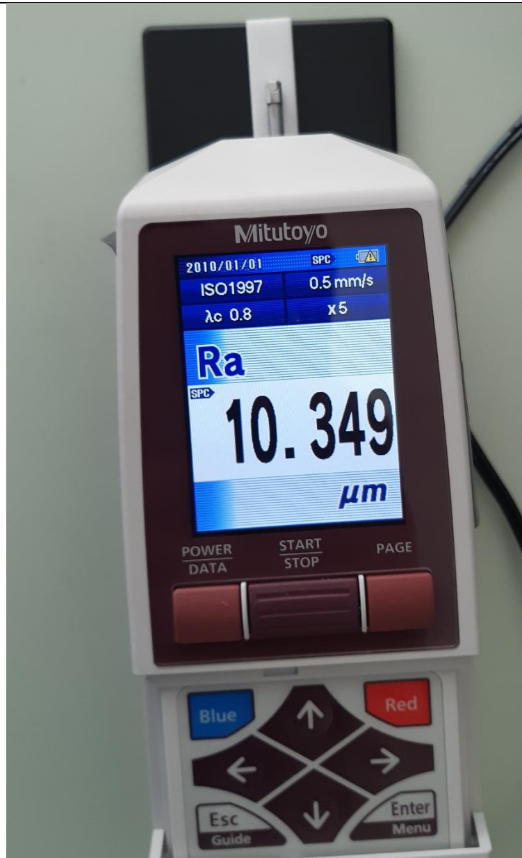
Slika 27. Prikaz mjerenja epruvete, i dobivene vrijednosti parametra R_a
