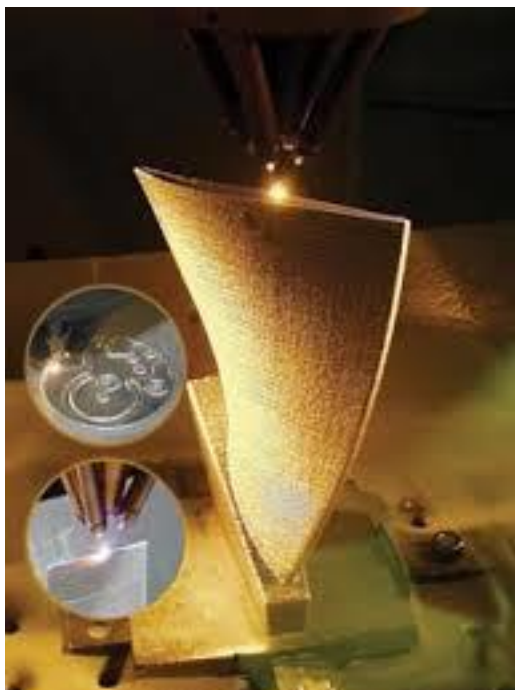
Slika 14. Primjer proizvoda načinjenog LENS postupkom [13]
