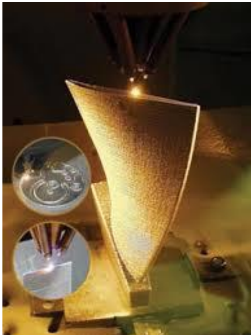
Slika 14. Primjer proizvoda načinjenog LENS postupkom [13]
