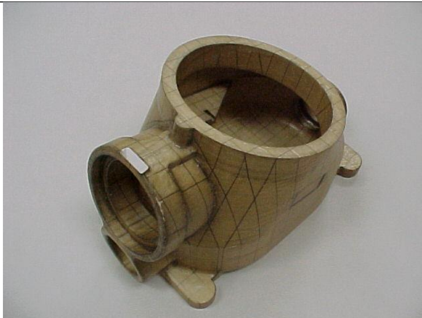
Slika 12. Primjer proizvoda načinjenog LOM postupkom [11]
