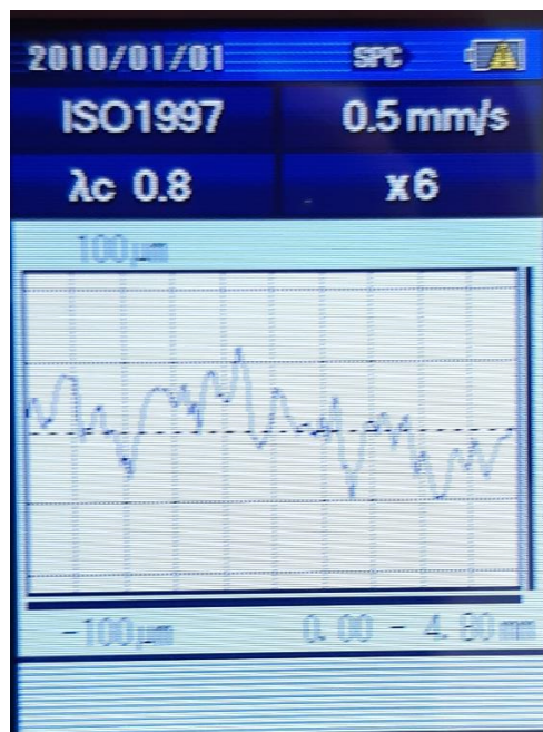
Slika 26. Grafički prikaz karakteristika površine
