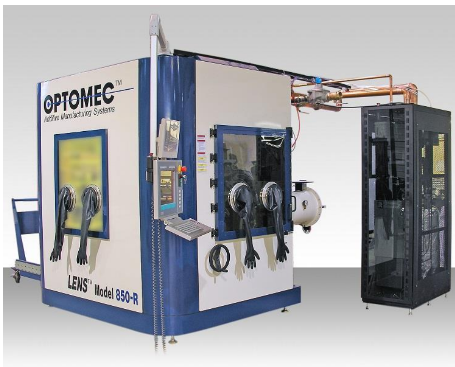
Slika 15. Stroj za izradu LENS postupkom [14]
