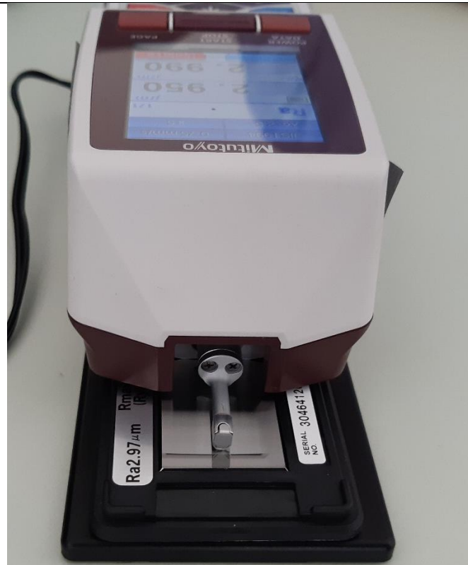
Slika 25. Prikaz kalibriranja pomoću etalona
