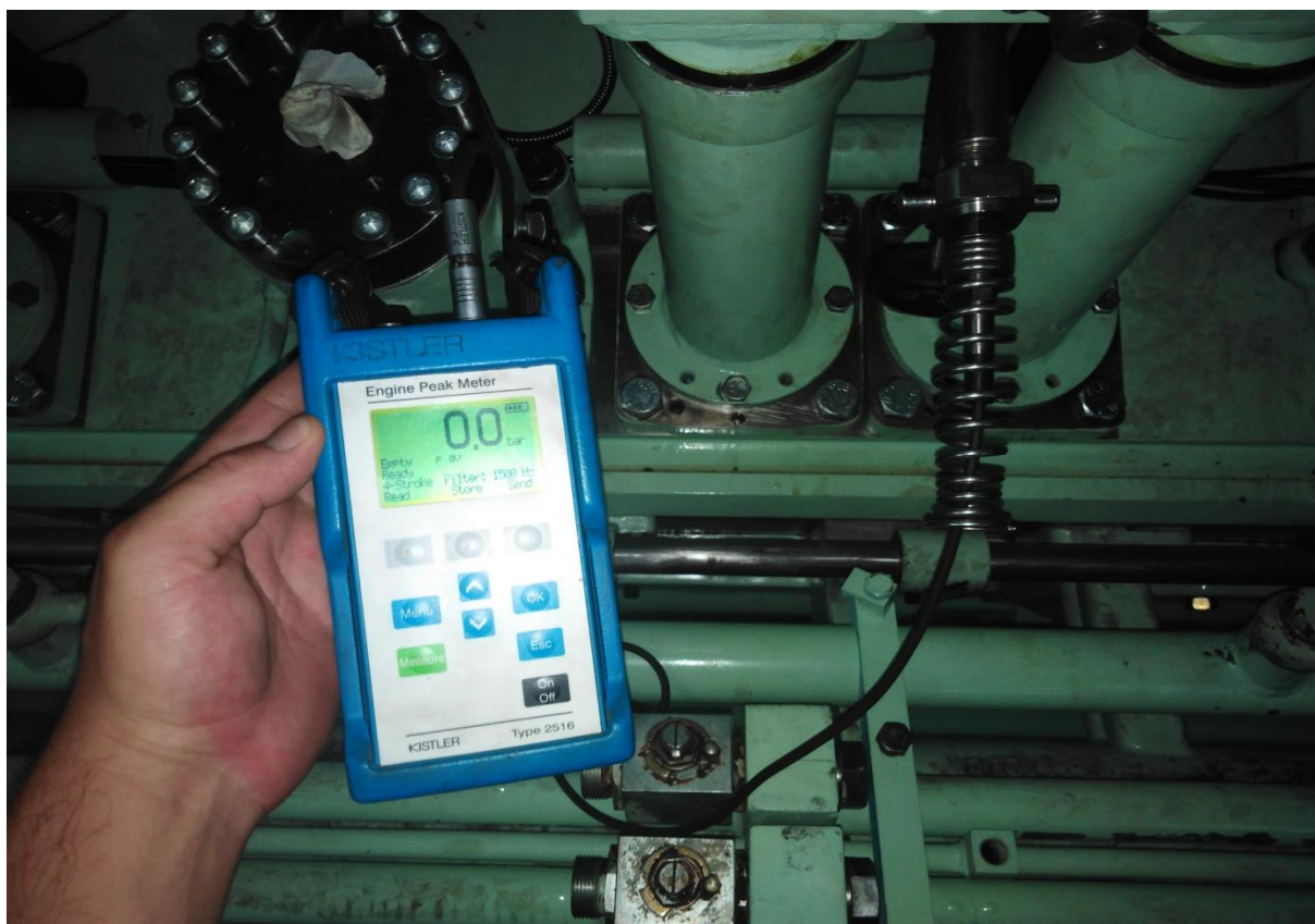
Slika 37. Predodžba mjerenja maksimalnih tlakova za vrijeme terećenja **
