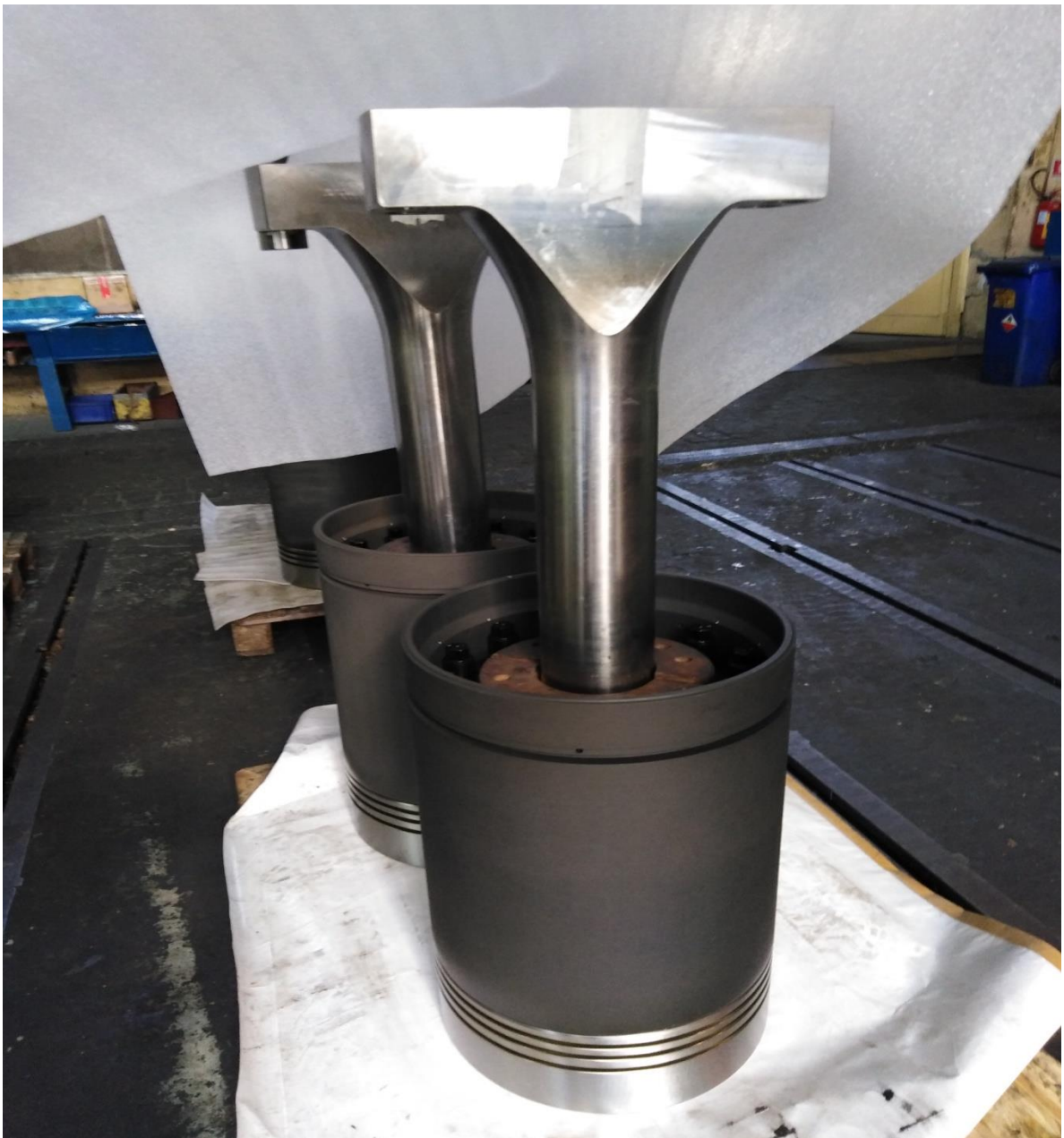
Slika 17. Predodžba složenog klipnog mehanizma prije montaže u motor
