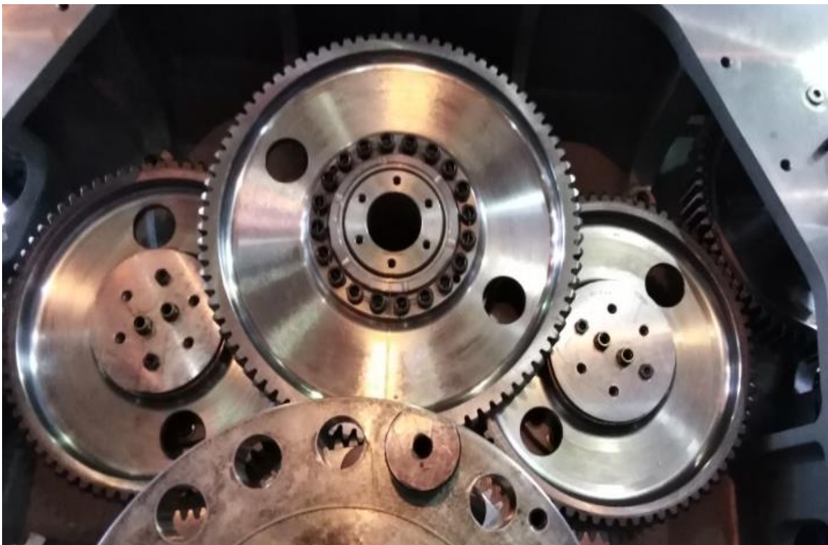
Slika 19. Predodžba razvodnog mehanizma *
