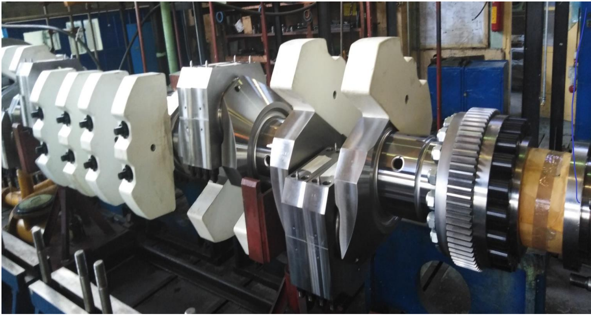
Slika 11. Predodžba koljenastog vratila ADRIA 40 s montiranim protutezima, letećim ležajevima i odzivnom osovinom **
