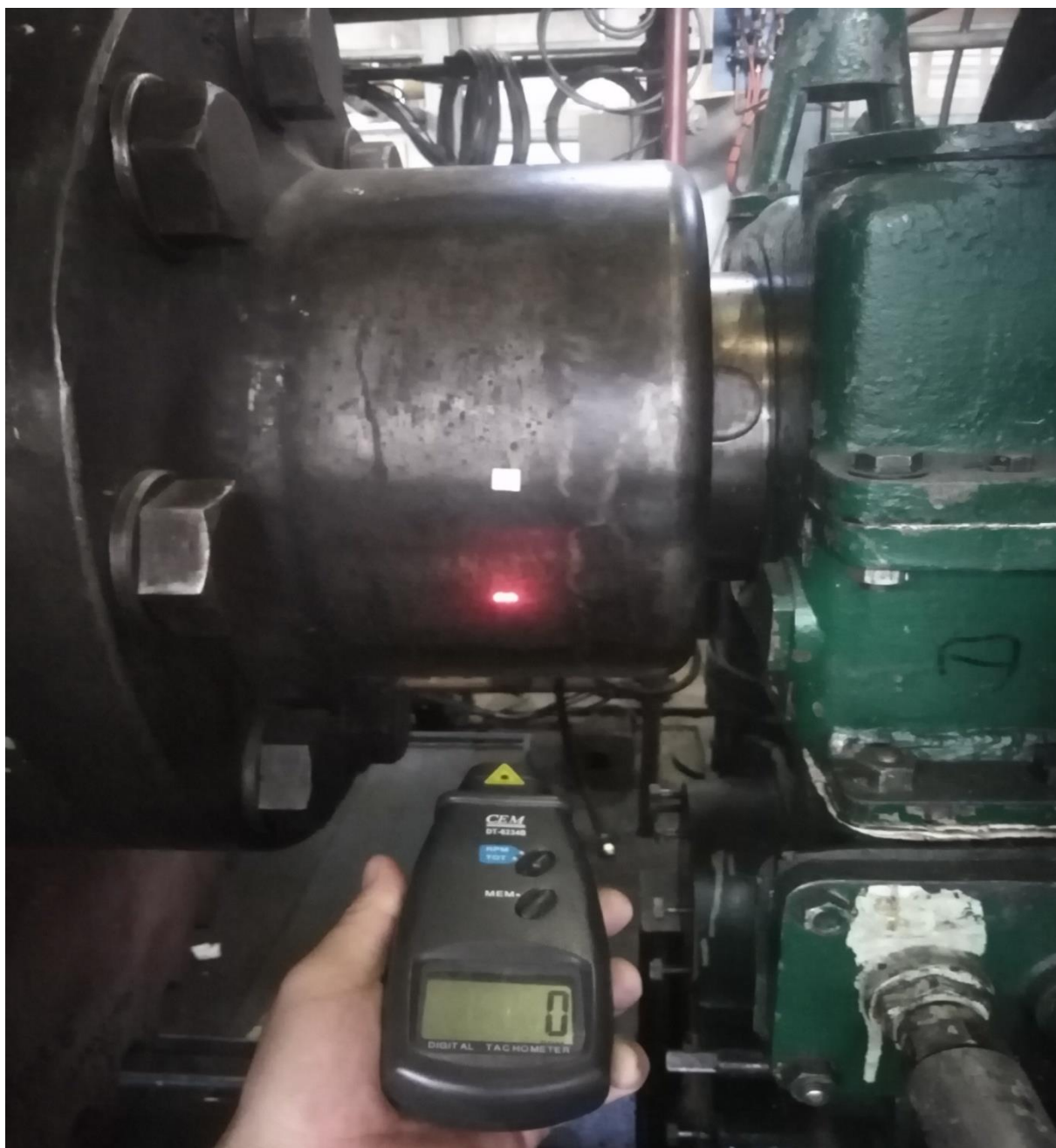
Slika 38. Predodžba mjerenja broja okretaja motora **
