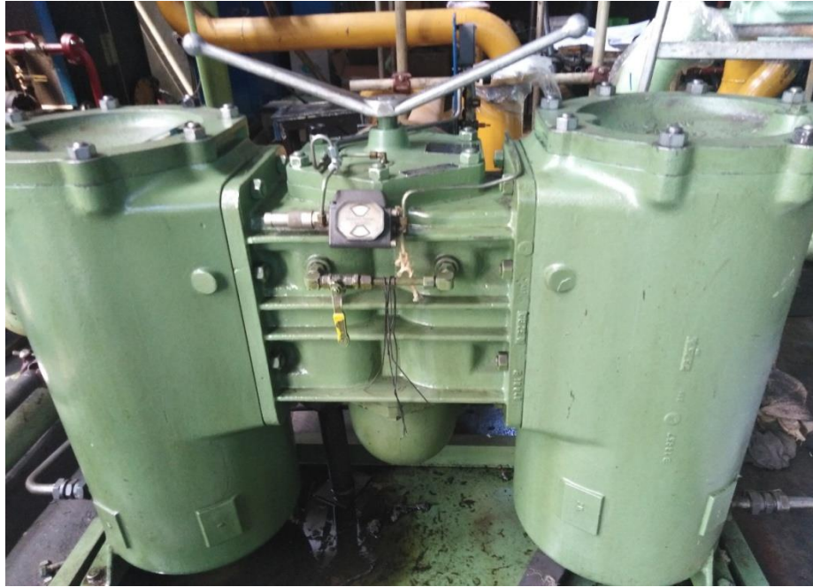
Slika 27. Predodžba čeličnih filtera ulja s magnetom ( 0,03 mm finoća )
