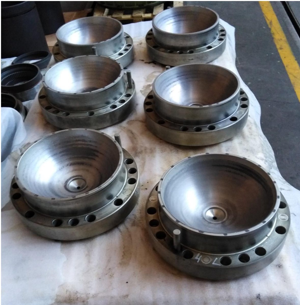
Slika 15. Predodžba rashladnih uložaka klipova ADRIA 40 **
